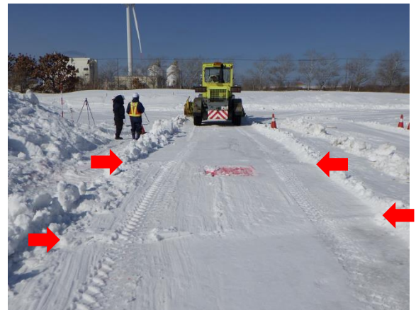
図-11 雪面上に残った除雪ブレード上下動の痕跡
