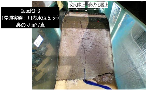
写真 3.11 浸透実験中の堤体裏のり面 (CaseR3-3)
