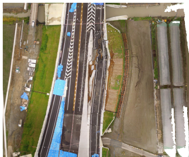
図-2.3 UAV空撮画像を基に作成したオルソ画像
