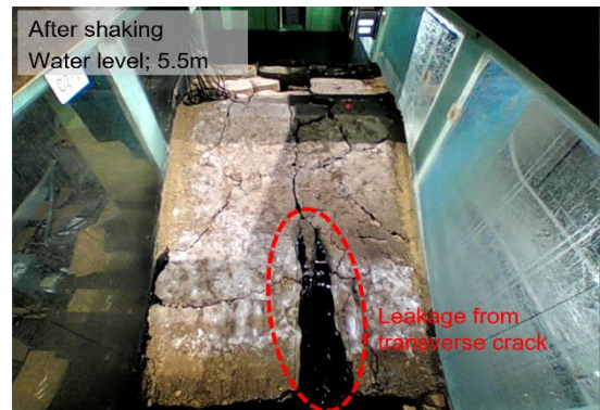
写真 3.8 実験後の堤体漏水の状況 (CaseR3-2)
