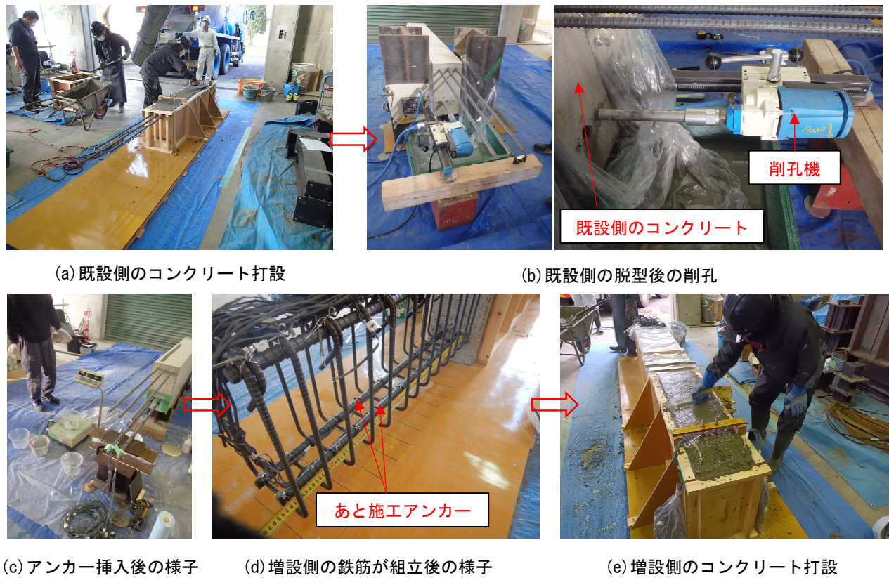
図-3.3 供試体の製作過程
