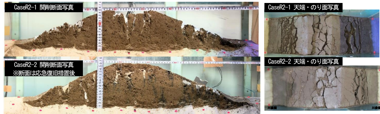
写真 3.7 実験後の堤体の亀裂状況(粘性土 : CaseR2-1, CaseR2-2)
