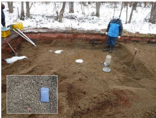
図-2.10 攪乱試料採取箇所の現場密度試験状況
