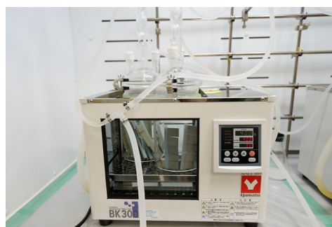
図12 浸せき試験状況
