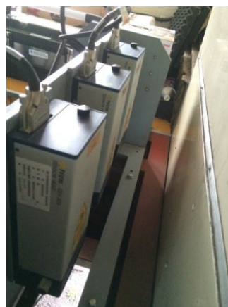
写真 3.3.3 ドップラ振動計
