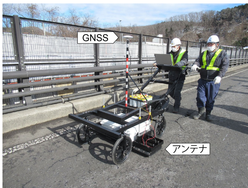
写真-4.6.1 中周波型カート式電磁波レーダ装置による調査
