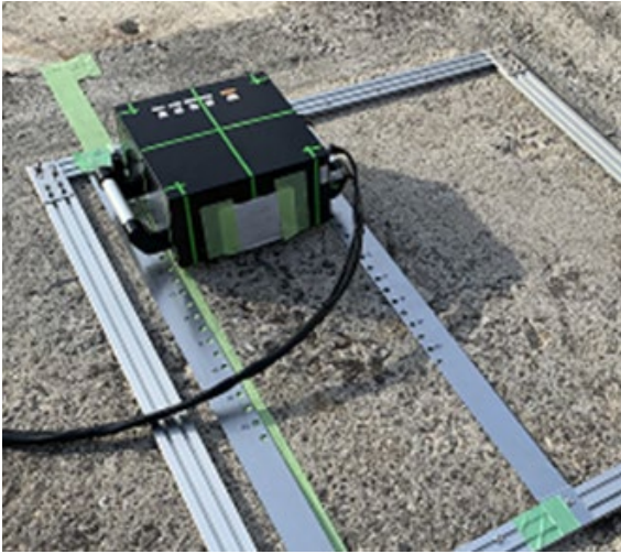
測定部に測定治具と本体を設置
