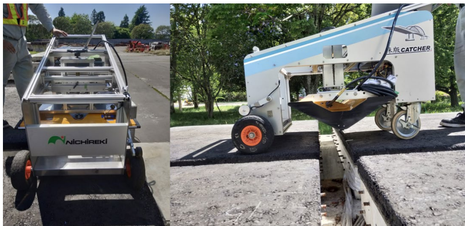
写真-6.2.2 手押し型電磁波レーダ装置外観 (左：正面, 右：側面)
