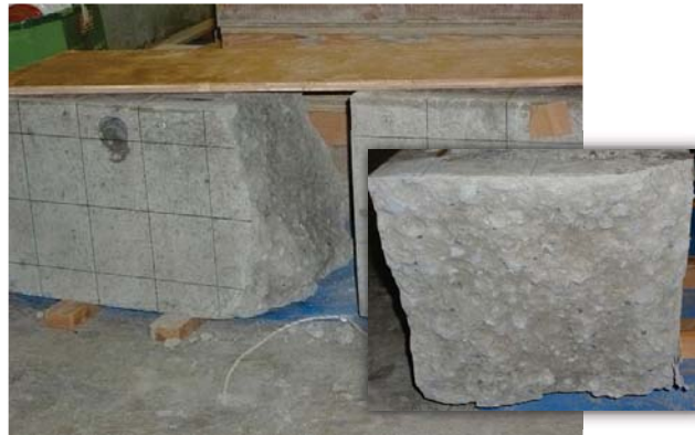
写真-2.1.3 曲げ載荷荷重時に破損したコンクリート供試体の状況
