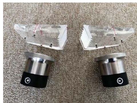
写真-3.1.2 反射の伝播速度測定時のくさび型シュー
