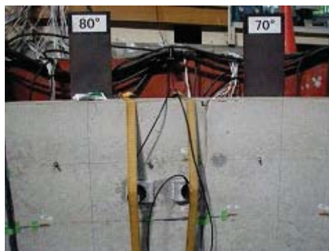
写真-3.1.3 76° 付近での伝播速度測定状況
