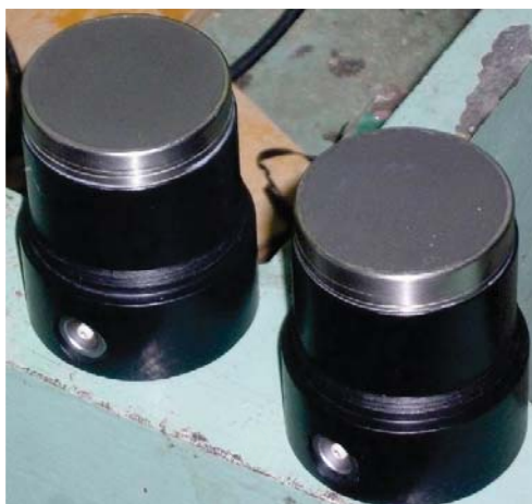
写真-2.1.1 使用したトランスデューサの外観
