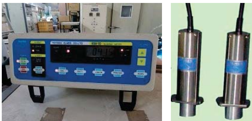
写真-3.2.2 分離型の簡易な伝播速度測定器の外観
