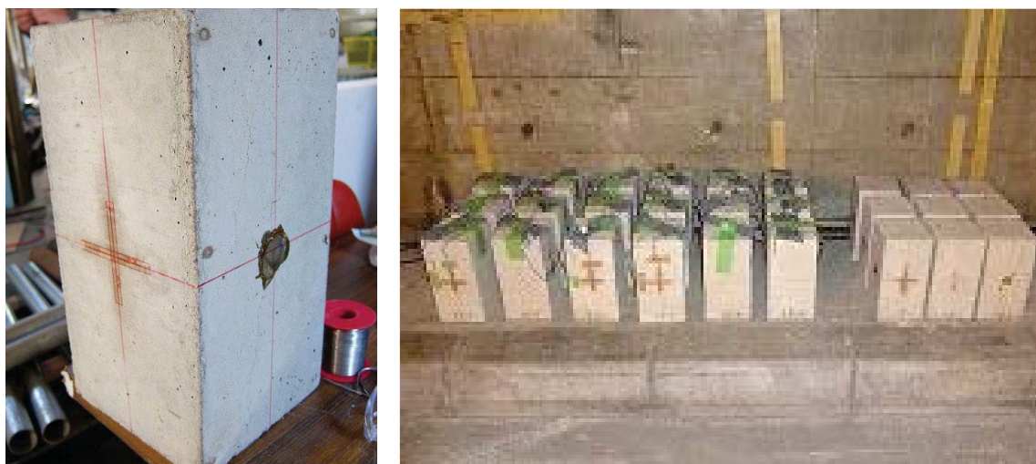
写真-2.2.3 角柱供試体（寸法：150mm×150mm×300mm）の外観
