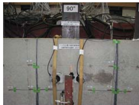
写真-3.1.4 90° 付近での伝播速度測定状況
