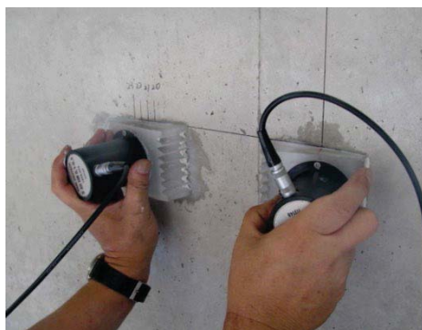
写真-3.1.2 反射の伝播速度測定時のくさび型シュー
