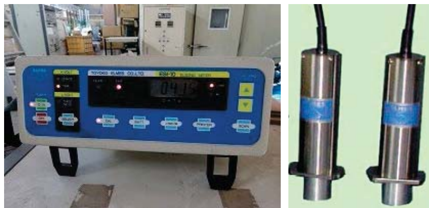
写真-2.2.1 分離型の簡易な超音波伝播速度計の外観
