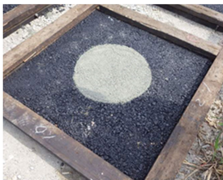
写真-4 模擬層間剥離作成
