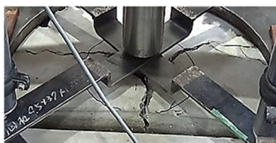
写真-4 割裂破壊の例
