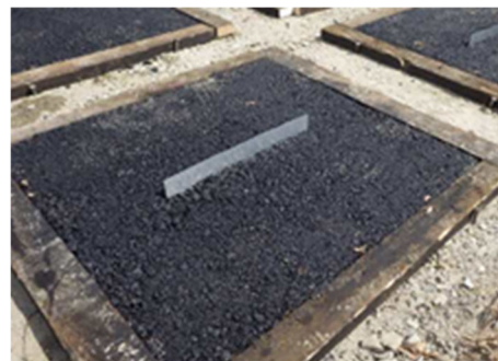
写真-2 模擬ひび割れ作成
