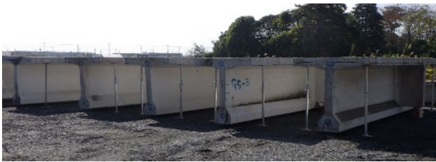
写真-1 撤去桁 (土木研究所に運搬後の状況)
