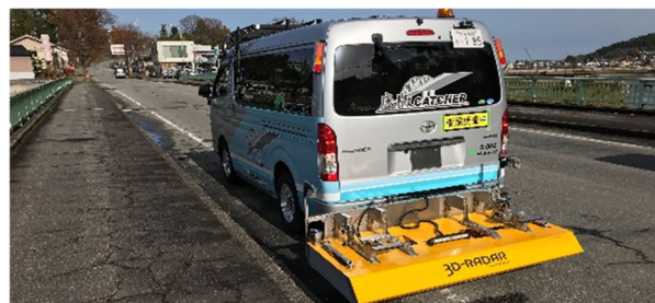
写真-6 電磁波レーダ計測状況
