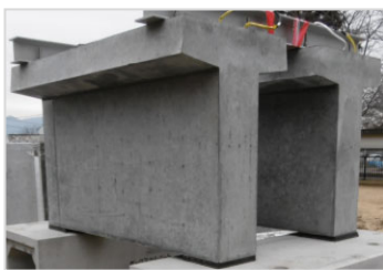
図-13 実大断面を有する供試体の設置状況
