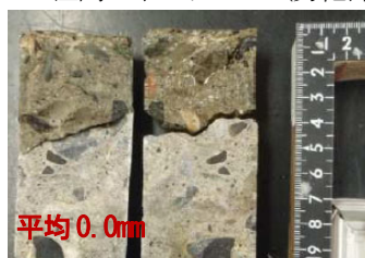
写真 4.3.4 含浸深さの測定状況（現地測定）
