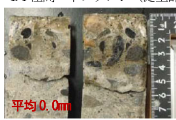
写真 4.3.4 含浸深さの測定状況（現地測定）
