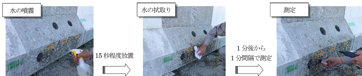
図 4.3.3 撥水性確認の測定概要
