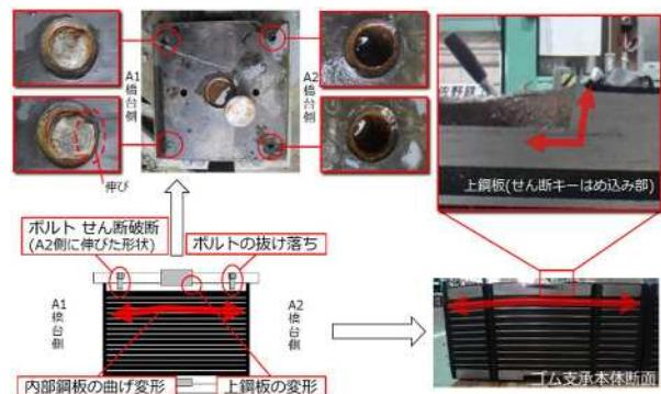
写真-2.2 A2G4 支承の損傷状態（上面及び断面）
