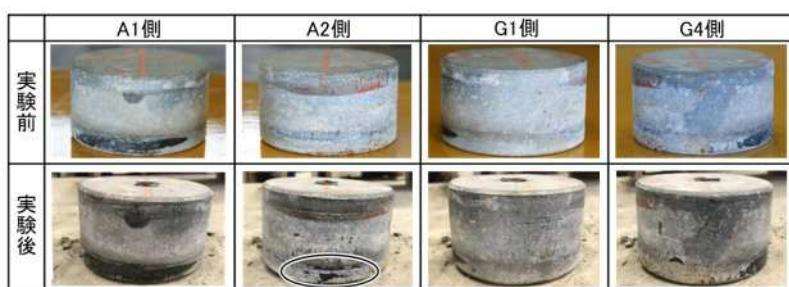
写真-2.6 実験前後における上側せん断キーの損傷状態
