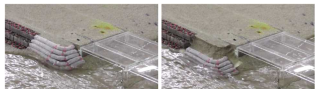
図-12 case3 河床低下に対応する屈撓性(左)と追従性(右)の状況
