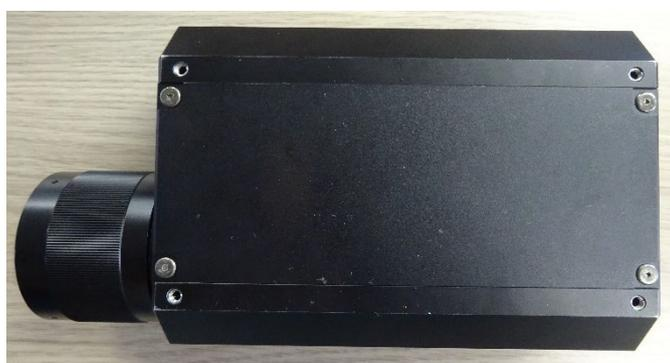
写真 4.1.1 試作機の架台固定位置（四隅にネジ穴）
