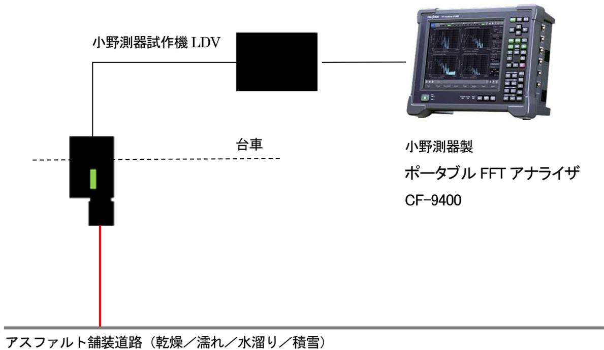
図 3.5.4 路面状態による測定の評価構成図
