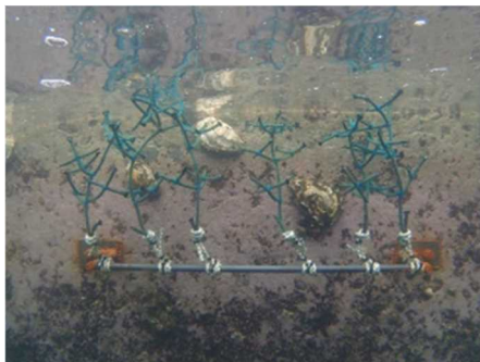
写真-4 直立壁面に設置直後の人工海藻の外観
