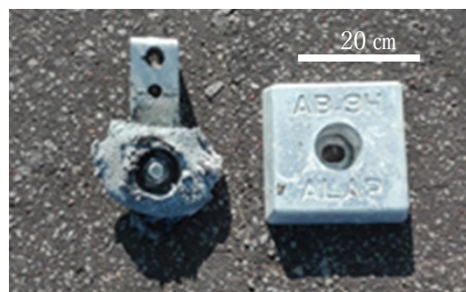
写真 5 電気防食のための亜鉛板状況 (左：2 年稼働後、右：設置時)
