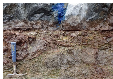
写真-1 ダム基礎で確認された弱層の例
