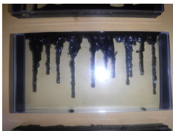
写真- 4.4.3 低弾性 190°Cでの浸透状況
