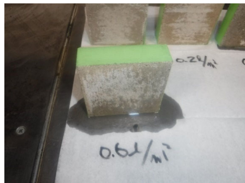
写真-付 1.5 0.6 L/m 2 塗布作業に支障はない。塗布量は過剰。プライマを Co 版に置いている 感じ。塗布直後に Co 版を垂直に立てると過剰にダレていた。
