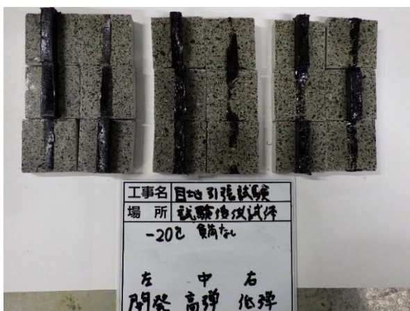
写真- 4.5.15 引張試験後供試体 -20°C負荷なし
