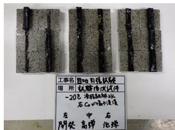
写真- 4.5.16 引張試験後供試体 -20°C 凍結融解 24 サイクル 右 Co が塩水浸漬
