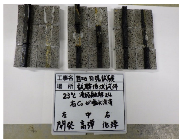
写真- 4.5.8 引張試験後供試体 23℃ 凍結融解24サイクル 右Coが塩水浸漬
