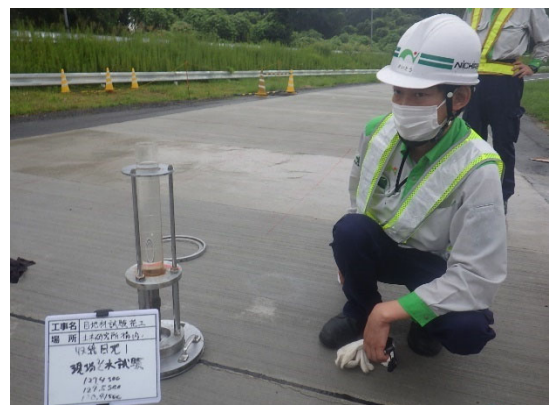
写真- 5.7.3 現場透水性試験状況
