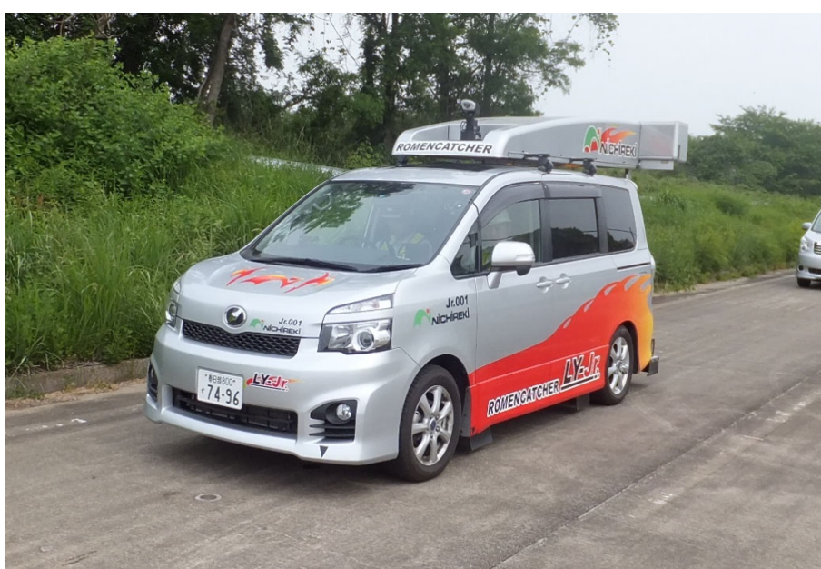
写真- 3.1.1 路面性状測定車の外観
