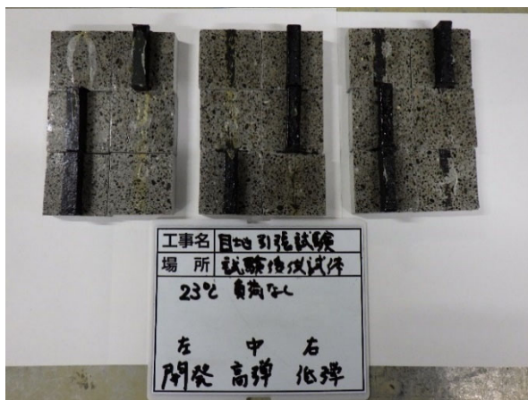
写真- 4.5.7 引張試験後供試体 23℃負荷なし
