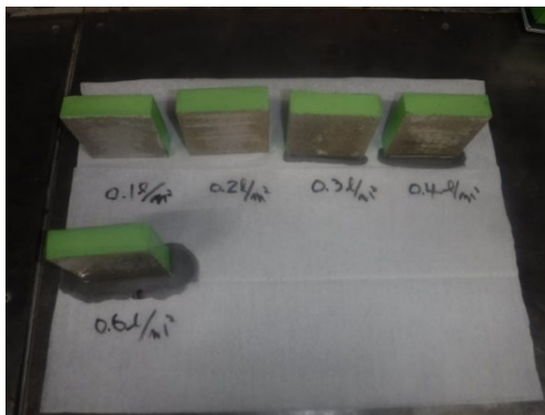
写真-付 1.6 ダレの状況 (全体)
