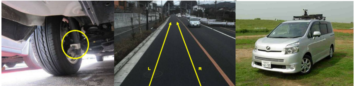
写真-3.1.2 (左)加速度計の位置, (中)車両走行の跡, (右)段差測定車の外観
