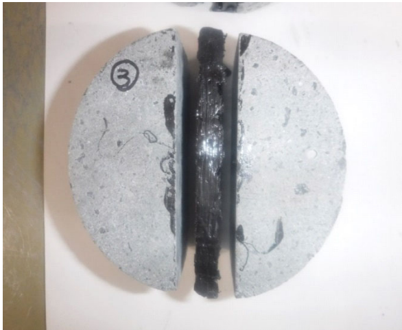
写真-付 2.8 供試体③接写 両側非接着
