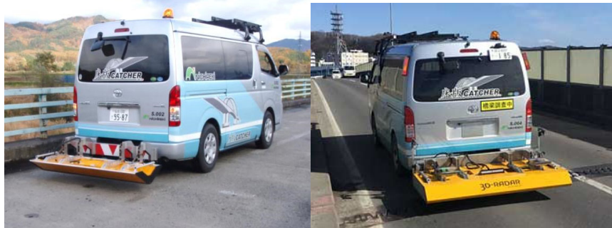
写真-3.1.3 電磁波レーダー（黄色）を搭載した測定車両の外観
