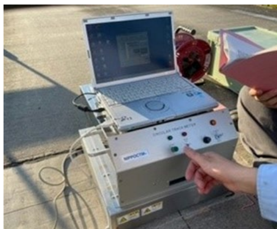
写真-4. 2. 3 CT メーターによる測定状況
