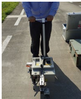
写真-4. 2. 4 MRP による測定状況
