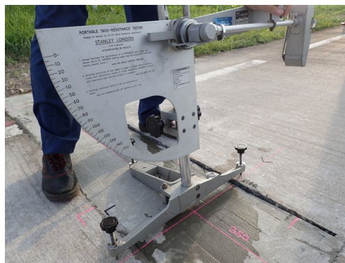
写真-4. 2. 6 振り子式スキッドレジスタンステストによる測定状況
