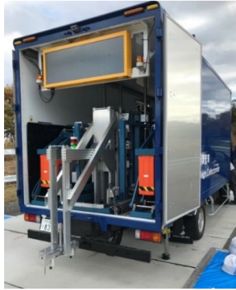
写真-4.3.2 FWD 測定状況
