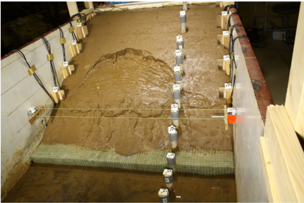
図 2.5.42 実験終了時の堤体の状況 (12/18 20:30)
