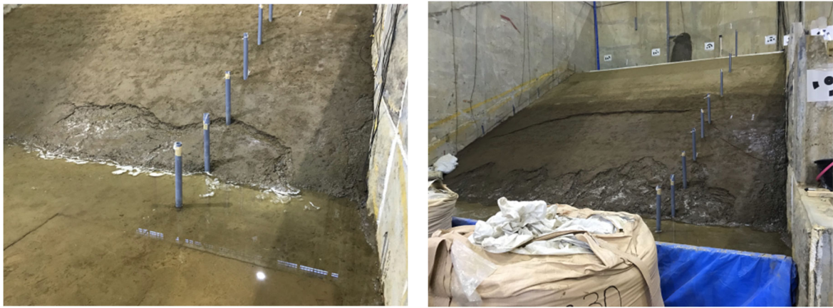
図 3.5.81 左：実験 1 日目終了時の状況、右：実験 2 日目クラック発生時の状況
