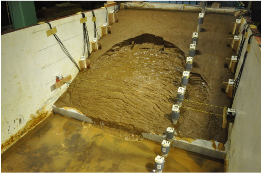
図 2.5.19 実験終了後の堤体の状況 (11/27 17:20)
