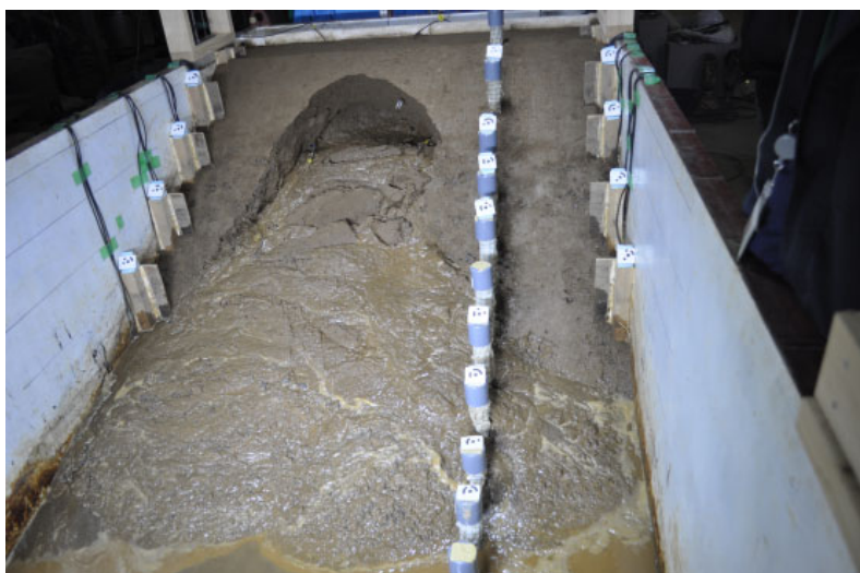
図 2.5.119 実験終了時の堤体の状況（12/19 16:10）
