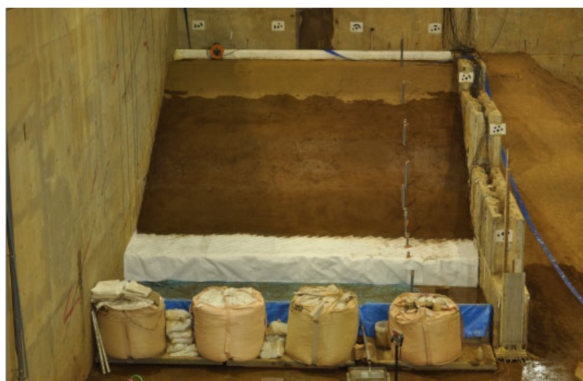
図 3.5.50 11 時間後（水位：堤体高の 90%）（3/16 20:00）
