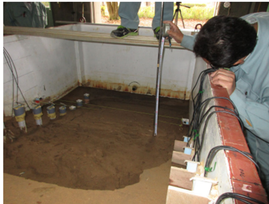
図 2.4.33 土層強度検査棒を用いたゆるみ範囲の計測状況
