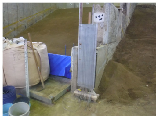
図 3.4.17 左：マンメータ一計測部設置状況、右：マンメータ一読取部設置状況
