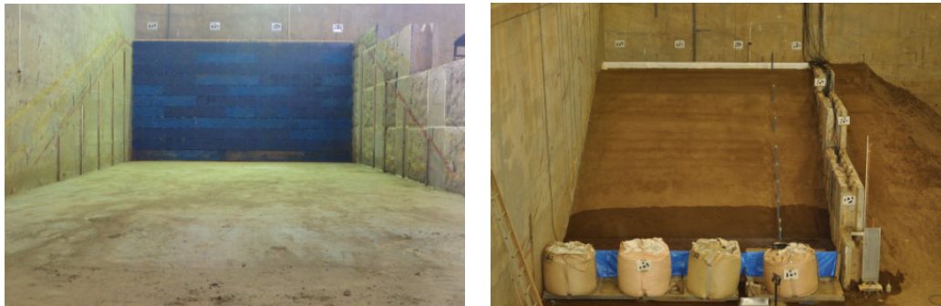
図 3.2.1 左：ピット全景、右：模型作製状況（無対策）
