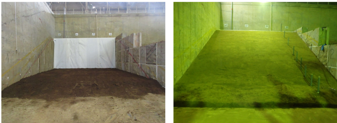
図 3.4.3 左：基礎地盤作製状況、右：堤体作製状況
