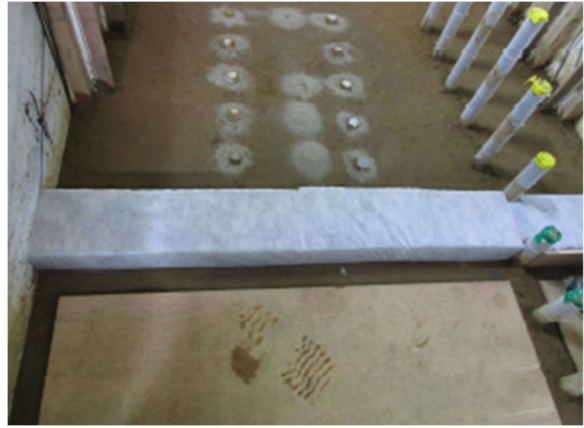
図 2.4.9 左：碎石充填後のドレーン工、右：ドレーン工設置状況（H29 Case2）
