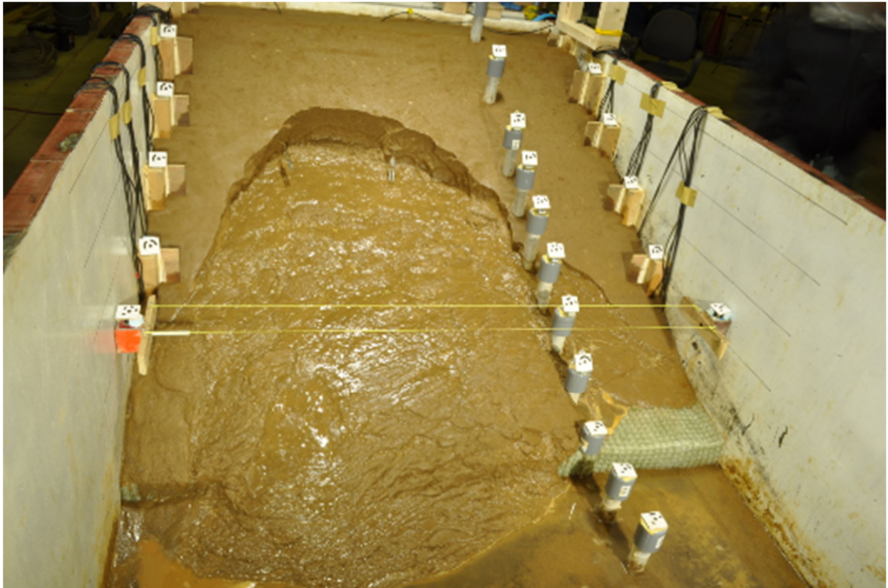
図 2.5.28 実験終了後の堤体の状況 (12/4 19:00)
