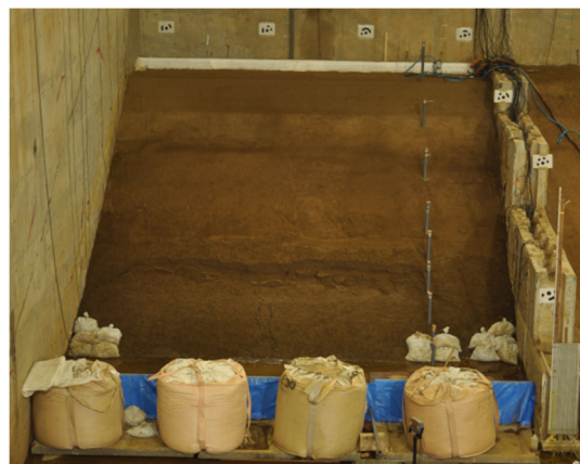
図 3.5.42 実験終了後 12 時間程度存置後の堤体状況
