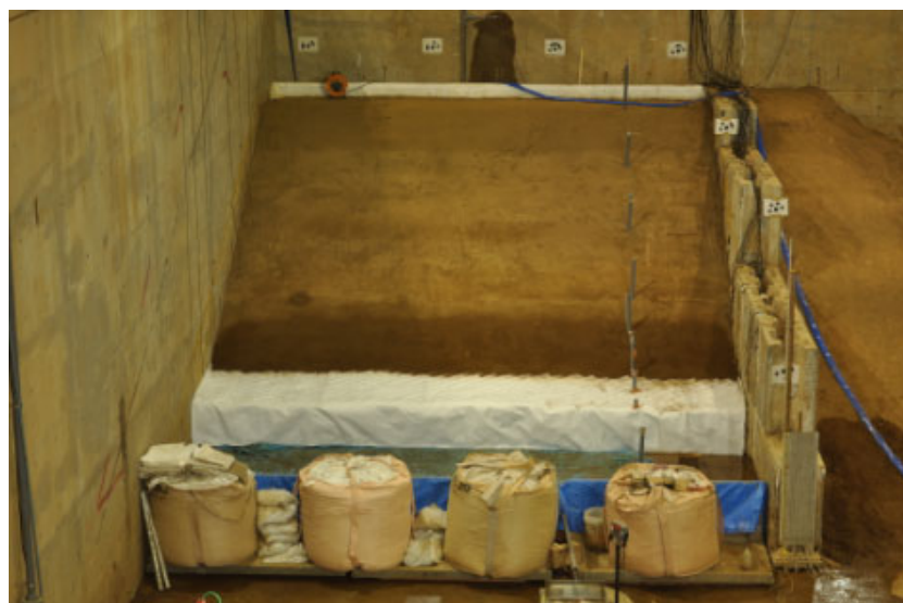
図 3.5.49 9 時間後（水位：堤体高の 70%）（3/15 18:00）
