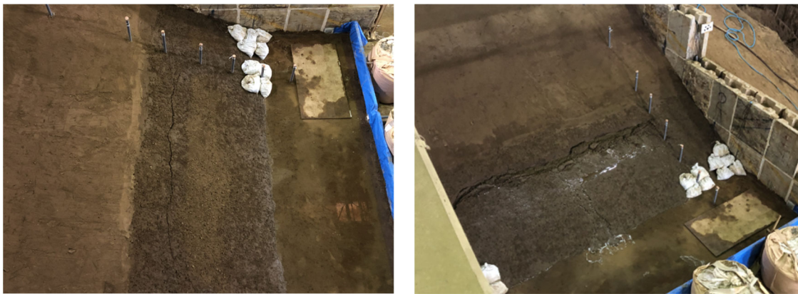
図 3.5.41 左：クラック発生時の状況、右：実験終了時の状況
