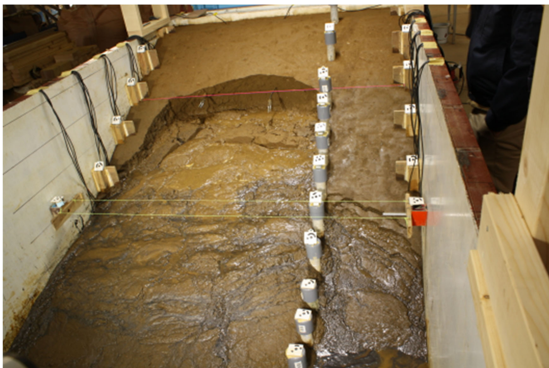
図 2.5.51 実験終了後の堤体の状況 (1/16 13:13)
