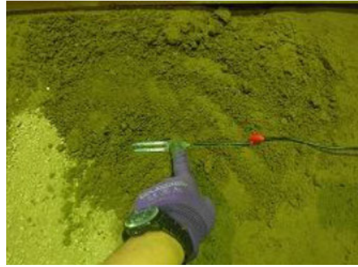
図 3.4.14 土壌水分計設置状況
