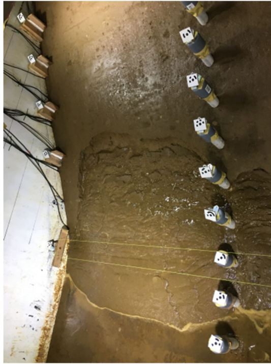
図 2.5.9 法面崩壊進行状況
