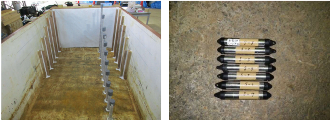
図 2.4.29 左：水位観測孔設置状況、右：使用水位計
