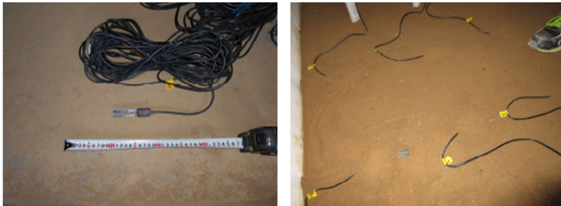
図 2.4.27 左：使用土壌水分計、右：土壌水分計設置状況
