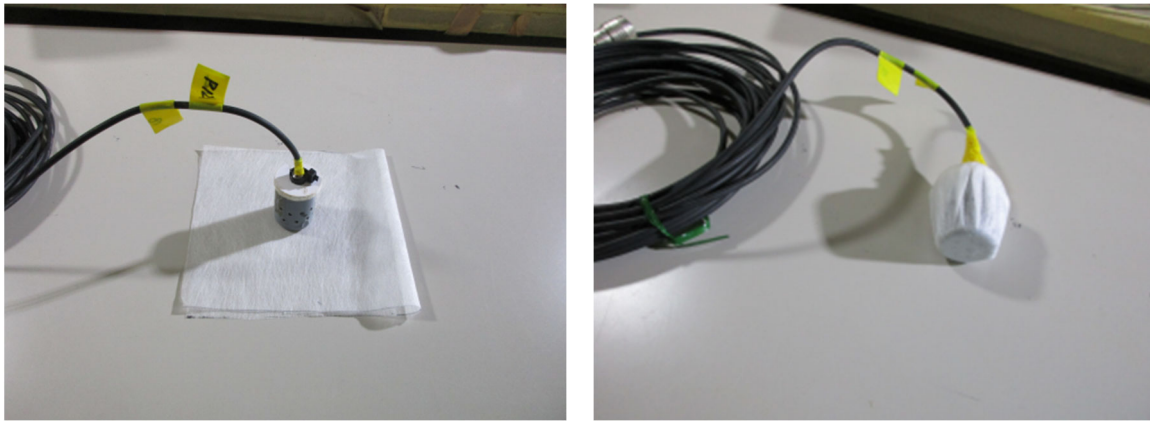
図 2.4.25 左：使用間隙水圧計、右：間隙水圧計センサー加工状況
