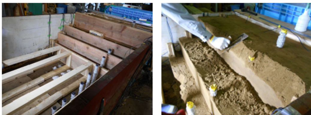
図 2.4.15 左：盛土部作製状況、右：盛土部法面整形状況
