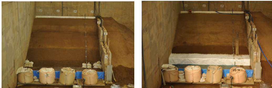
図 3.2.2 左：模型作製状況（礫混合土置換工法）、右：模型作製状況（ドレーン工法）
