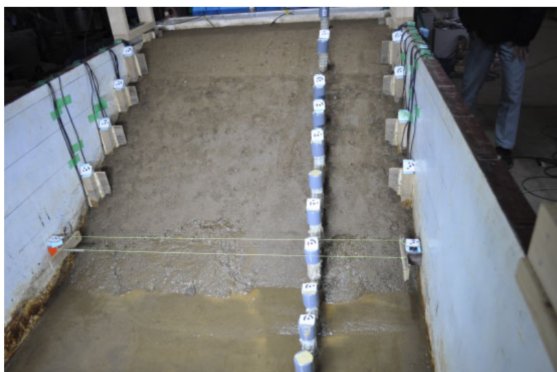
図 2.5.111 実験終了時の堤体の状況 (12/12 14:25)
