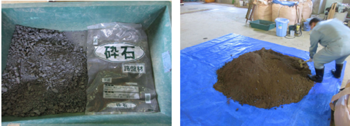
図 2.4.12 左：使用路盤材、右：礫混合土作製状況
