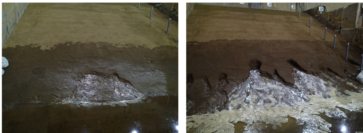
図 3.5.20 左：破壊進行初期（すべり破壊）の状況（17:15） 右：破壊進行モード変化後（侵食破壊）の状況（17:38）
