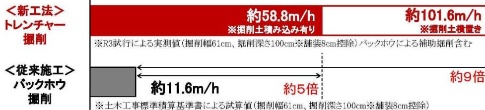
図-2.7 トレンチャーの活用により、掘削速度が大幅に向上 (令和4年度第1回無電柱化推進のあり方検討委員会資料より引用)
