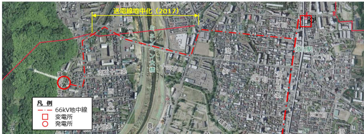
図-4.2 送電線地中化事例（札幌市豊平川ミュンヘン大橋）
