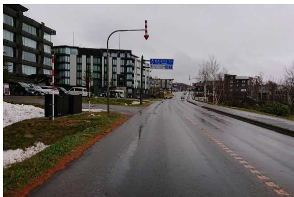
写真-2.9 十分な離隔をとった地上機器
