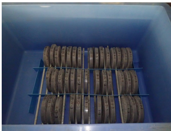
参考写真 1.2.1.1 浸せき試験時の試験片設置状況
