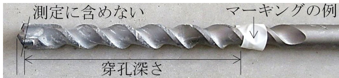
写真 2-3 ドリルの刃に施す穿孔深さのマーキングの例
