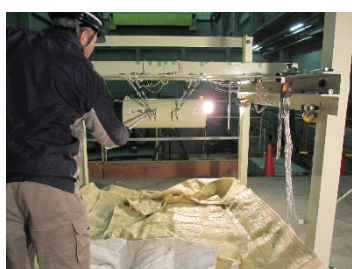
(a) シャックルピンの引抜き状況 (ターンバックルの破断を模擬)
