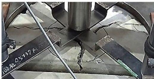
写真 4-8 割裂破壊の例
