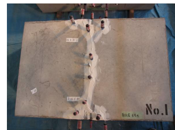
(c) ひび割れ注入完了
