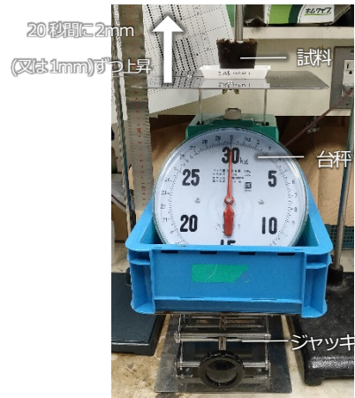
図 33 ゼリー強度の簡易測定装置
