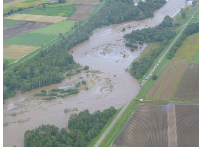
写真-6 流路変動による側岸侵食(音更川, 2011年出水, 帯広開発建設部提供)
