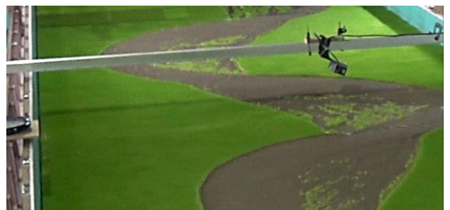
写真-8 河岸植生が流路変動や河岸侵食に与える影響に関する水理実験の実施状況
