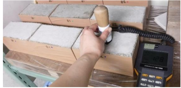
写真-4 電気抵抗式水分計による測定状況
