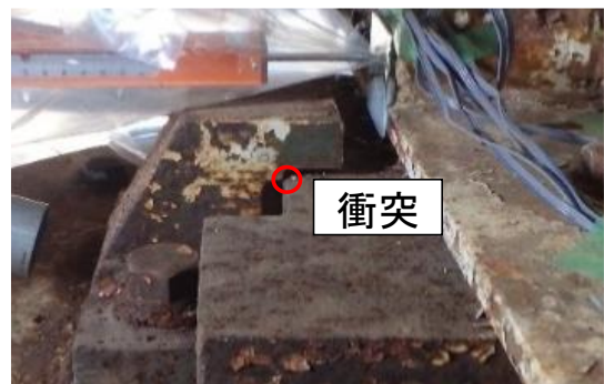
図-5 サイドブロック衝突時の状況
