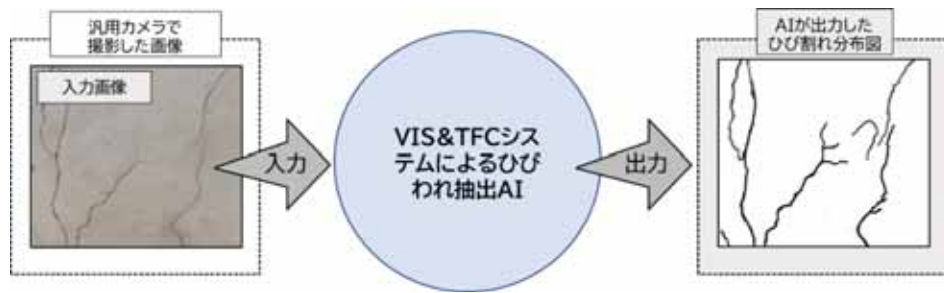
図 4-13-5 VIS&TFC システムによるひびわれ抽出 AI の推論フロー図
