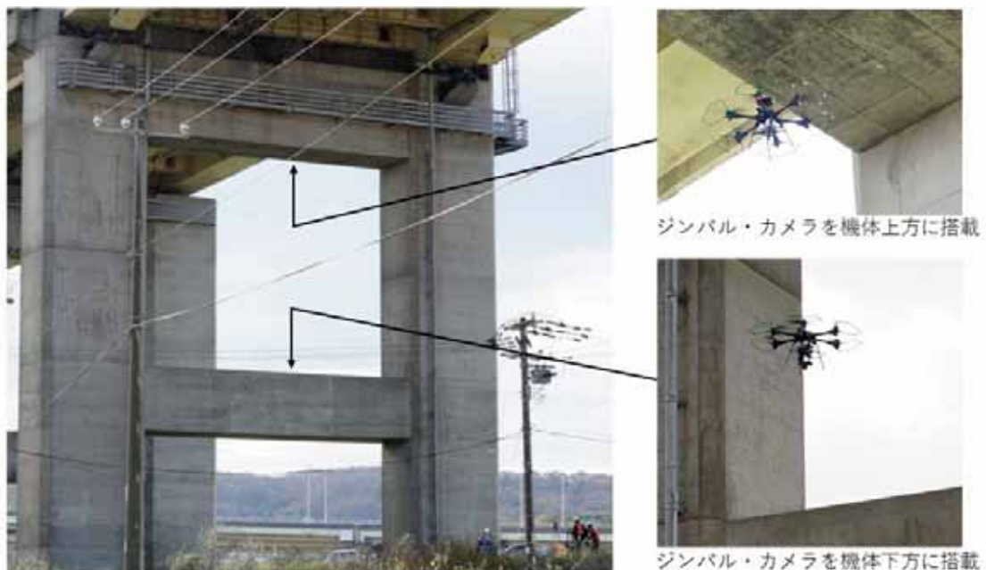
図 4-11-7 ジンバル・カメラの搭載位置と撮影対象
