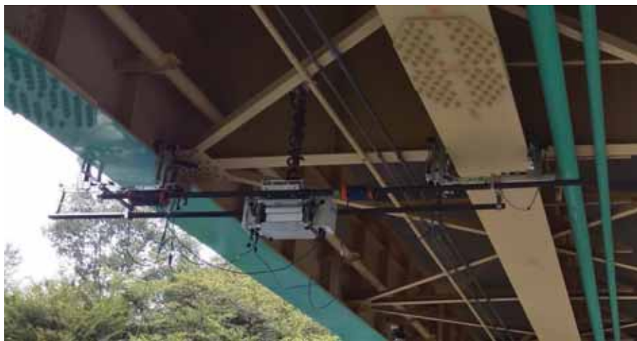
写真 4-3-1 主桁下フランジ把持式点検ロボット Turrets
