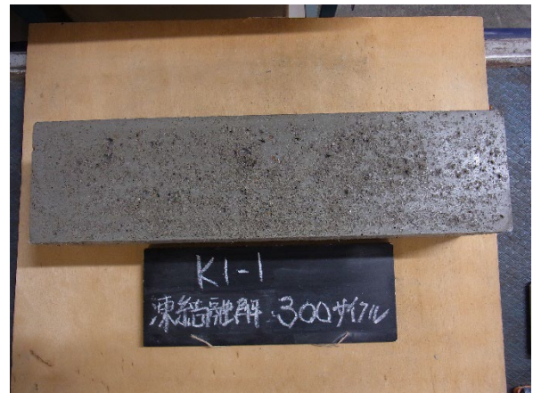
写真-3.2.6 凍結融解作用後供試体 (左 : 50 サイクル 右 : 300 サイクル)
