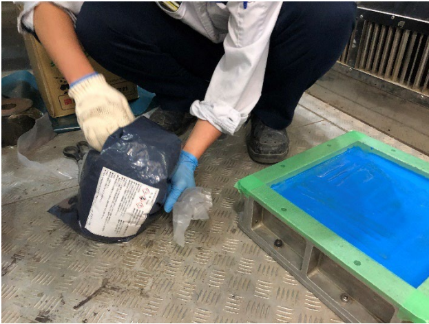
写真-3.1.13 材料練混ぜ状況（左：HCP，恒温室内 右：早強モルタル，実験室内）
