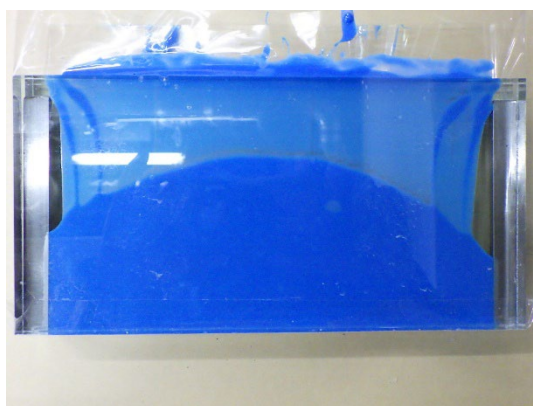
写真-3.2.2 浸透性試験後供試体
