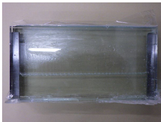
写真-3.2.1 浸透性試験後供試体
