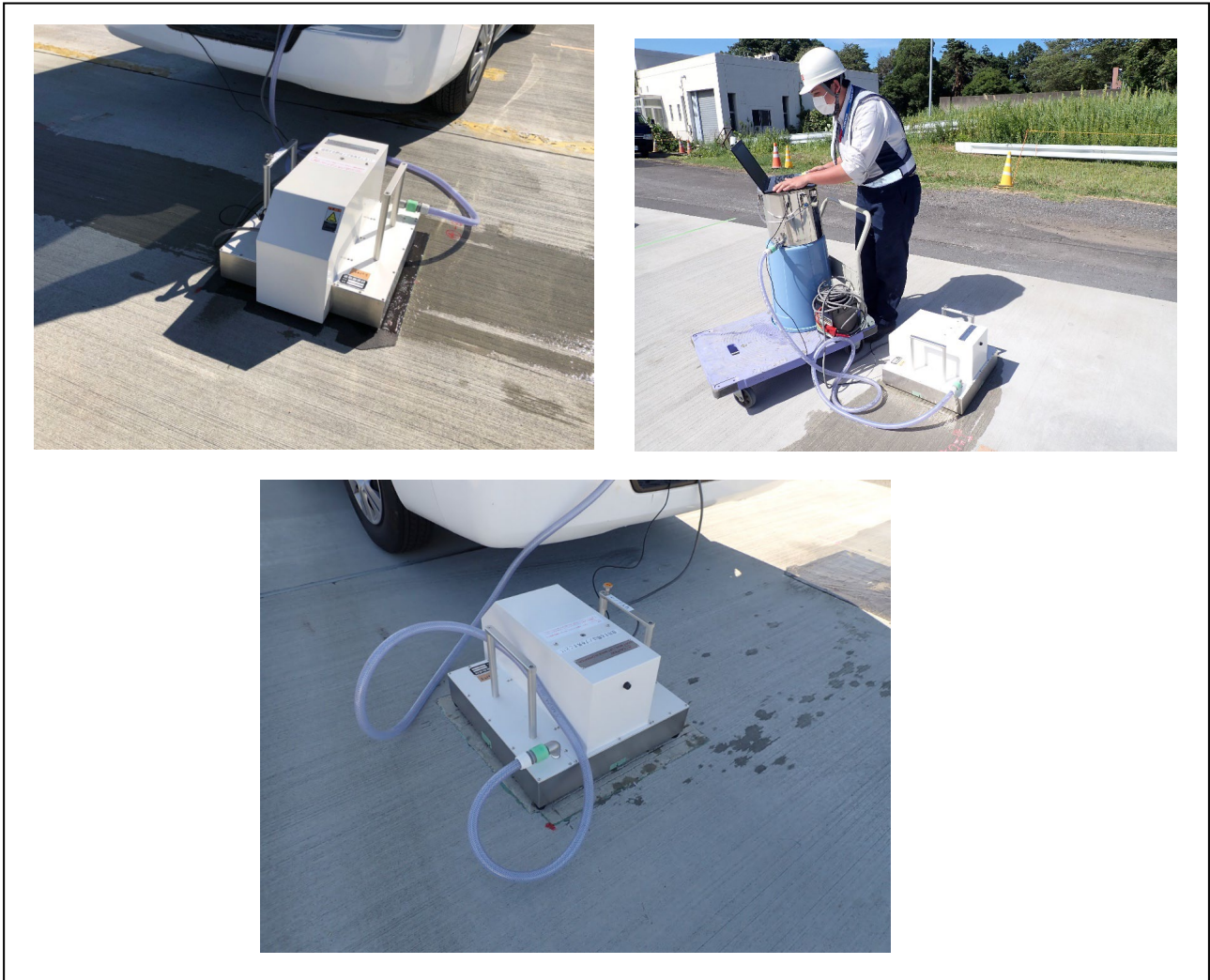
写真-4.7.4 回転式すべり抵抗測定器による動摩擦係数測定状況
