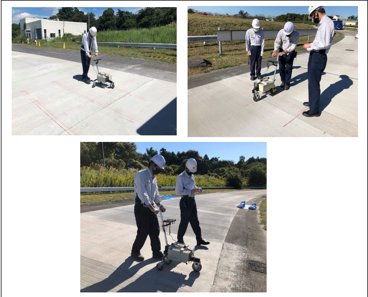
写真-4. 7. 7 MRP による表面形状測定状況
