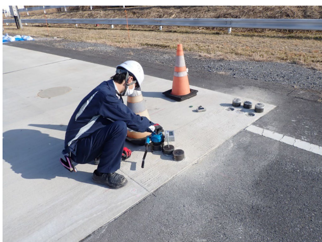
写真-4.7.9 引張試験状況（屋外暴露+過重負荷作用）
