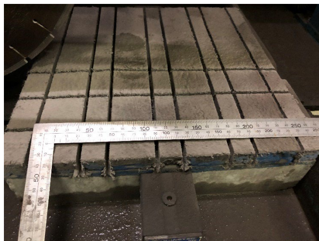
写真-3.1.15 カッターによる切断
