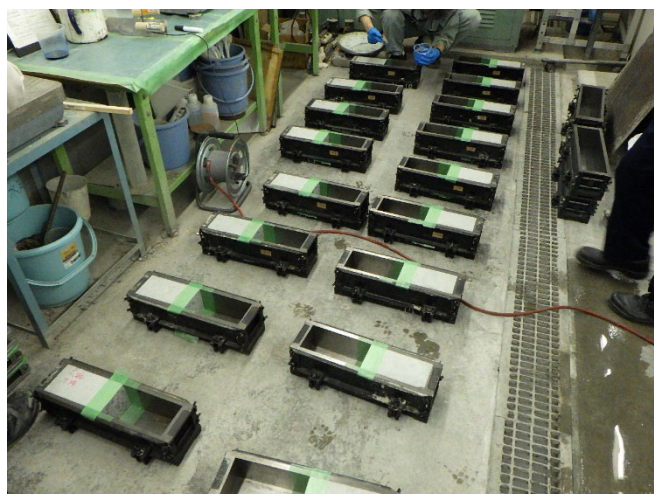
写真-3.1.22 複合供試体の作製状況
