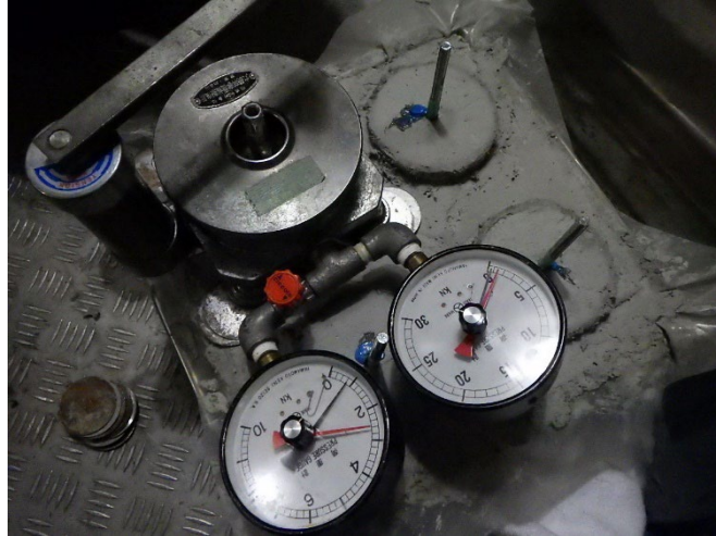
写真-3.1.20 建研式引張接着試験状況
