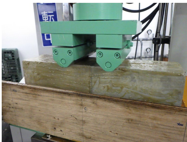
写真-3.1.23 接合供試体を用いた曲げ疲労試験
