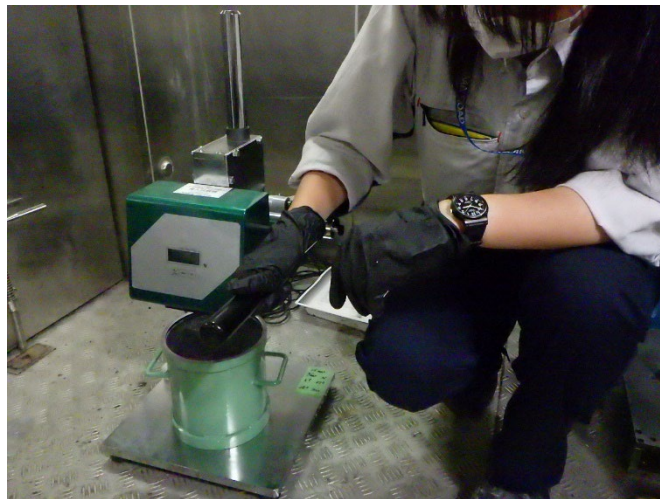
写真-3.1.5 凝結時間試験
