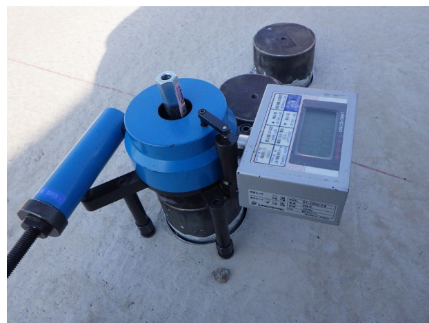
写真-4.7.9 引張試験状況（屋外暴露+過重負荷作用）
