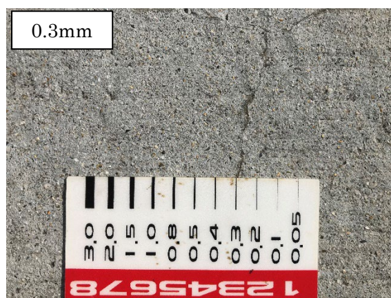
写真-4.3.10 プラスチック収縮ひび割れ (左：171万輪走行後，右：211万輪走行後)
