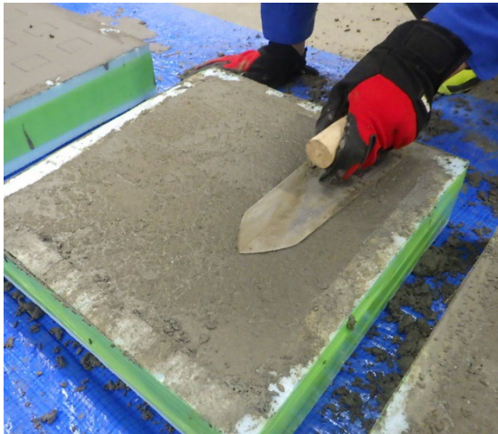
写真-3.1.5 補修材打設状況 (左：PCM，右：PCM-F)
