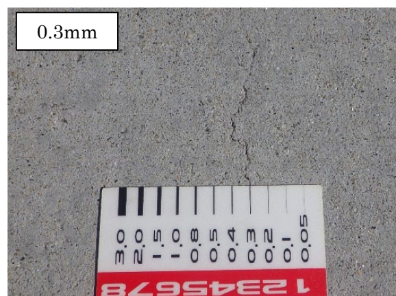
写真-4.3.10 プラスチック収縮ひび割れ (左：171万輪走行後，右：211万輪走行後)
