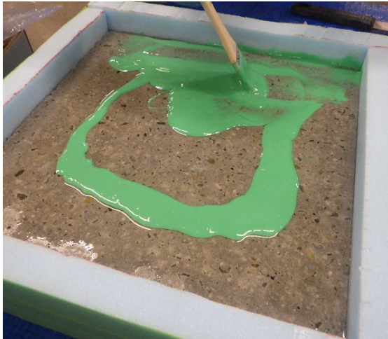
写真-3.1.4 接着剤塗布状況 (左：エポキシ系，右：ゴム系)
