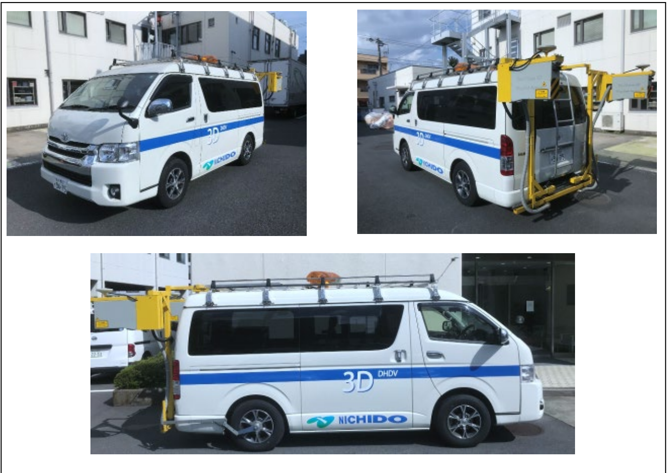
写真-3.1.1 3D測定車の外観
