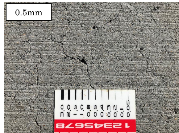
写真-4.3.13 プラスチック収縮ひび割れ（左：171万輪走行後，右：211万輪走行後）
