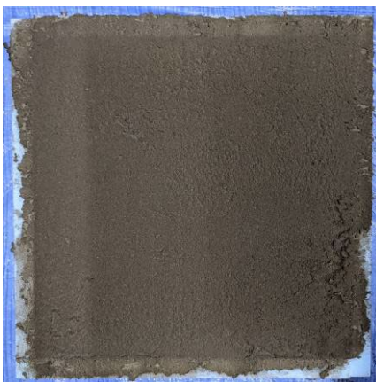
写真-3.2.3 PCM-a 打設後
