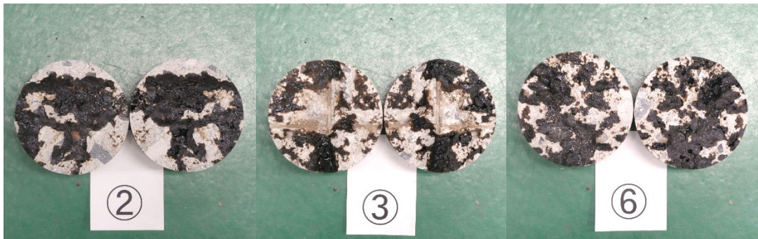
写真-4.5.31 引張接着強度試験後供試体②③⑥（ガス層—コンクリート床版間）
