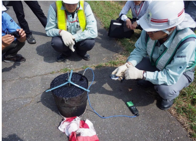
写真-4.5.7 リュエル流動性試験状況
