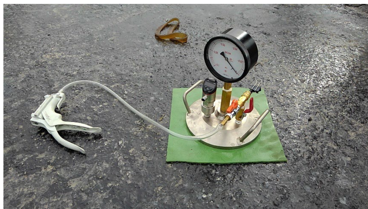
写真-4.5.33 透気試験状況
