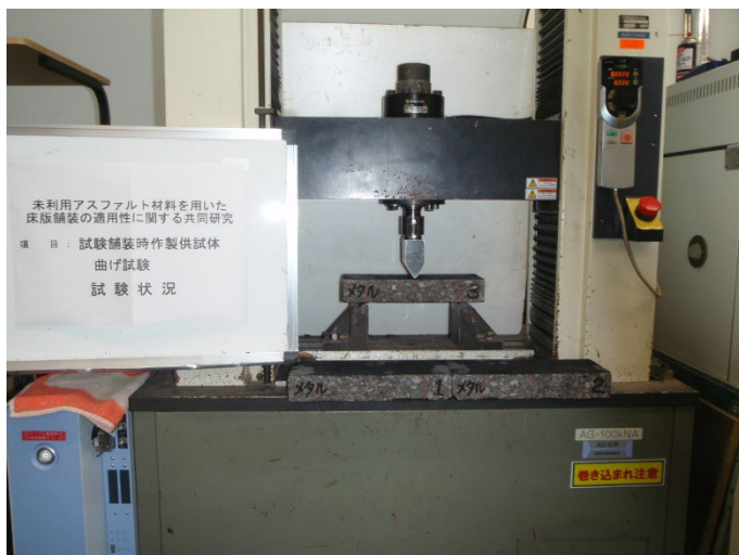
写真-4.5.11 曲げ試験状況
