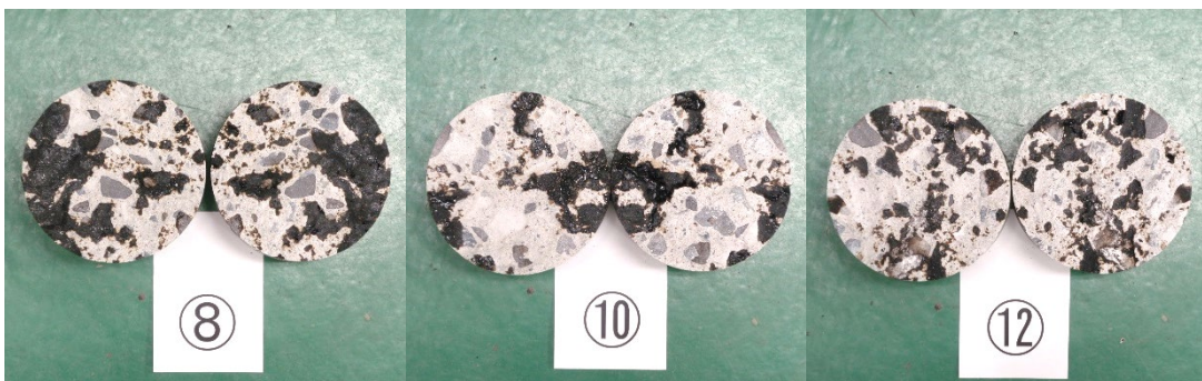
写真-4.5.32 引張接着強度試験後供試体⑧⑩⑫（ガス層—コンクリート床版間）
