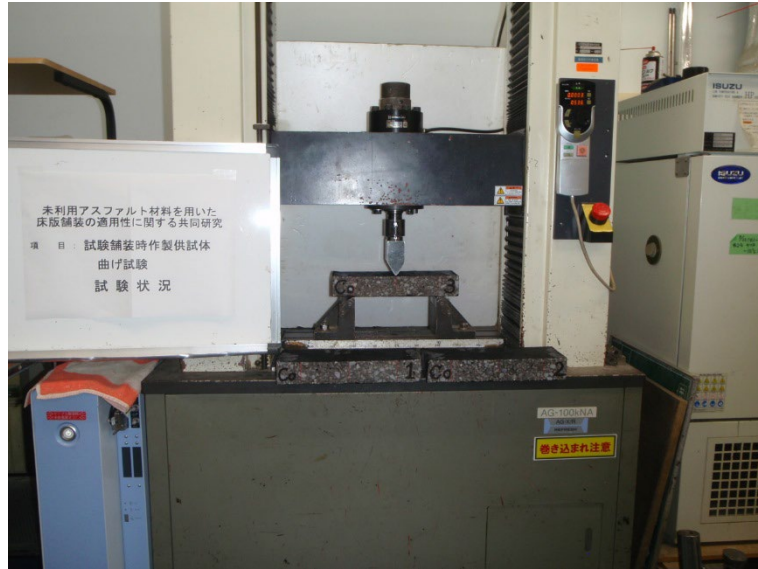
写真-4.5.25 曲げ試験状況
