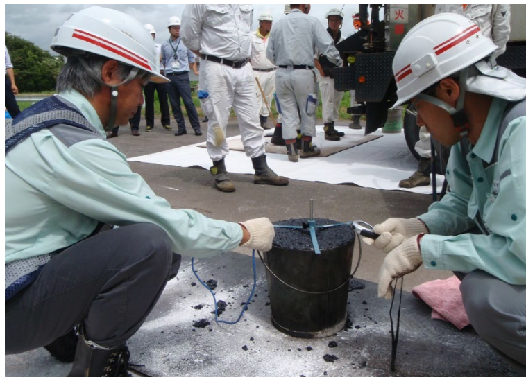
写真-4.5.23 リユエル流動性試験状況
