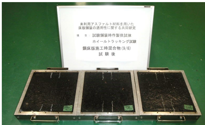
写真-4.5.10 ホイールトラッキング試験後供試体
