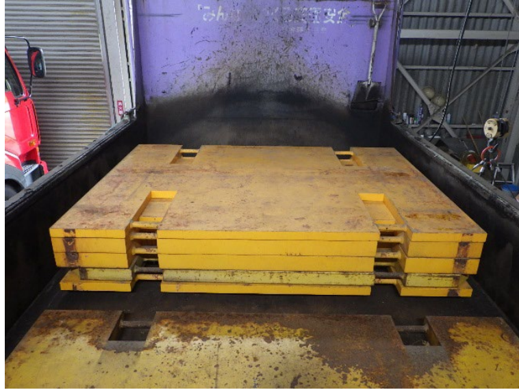
写真-4.5.34 荷重車に積んだ荷重調整ウエイト
