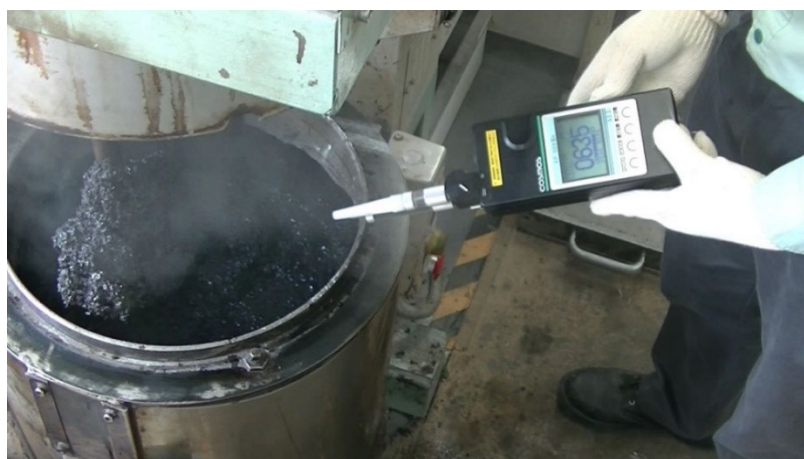
写真-4.3.1 ニオイセンサによる臭気測定状況
