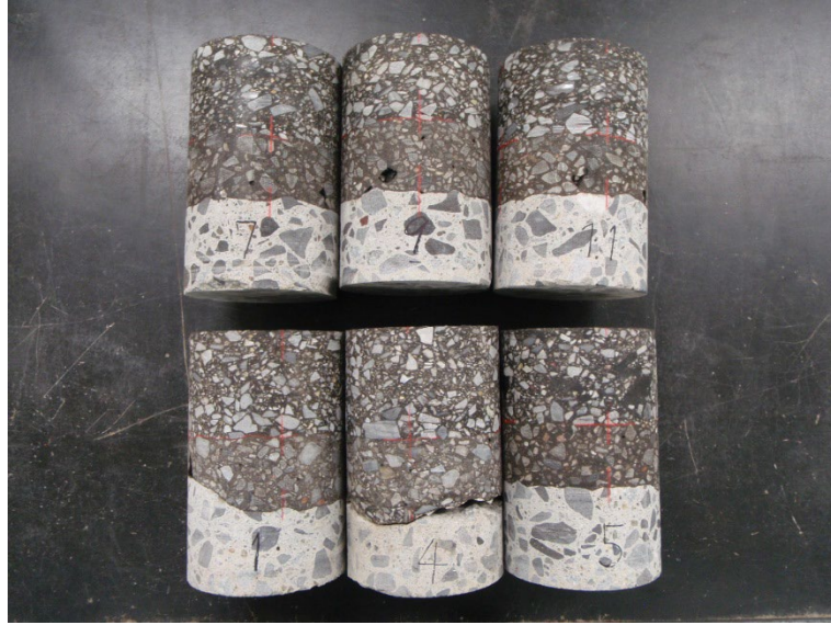
写真-4.5.27 採取コア（舗装厚さ・密度・加圧透水試験用：全6個）
