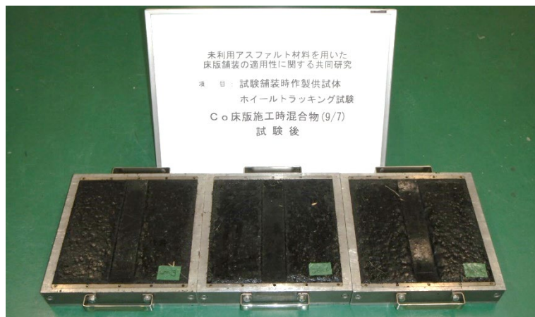
写真-4.5.24 ホイールトラッキング試験後供試体
