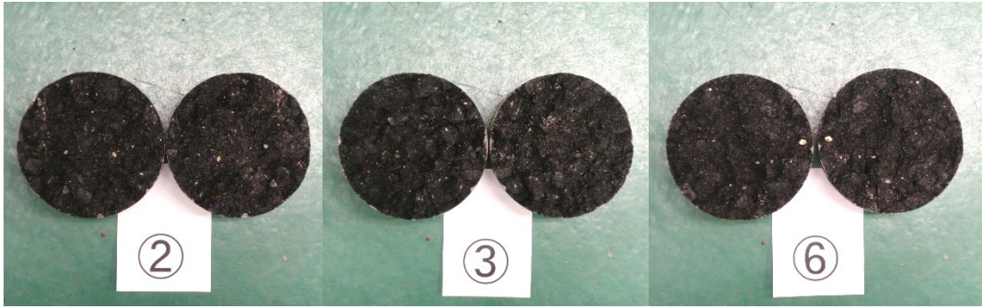
写真-4.5.29 引張接着強度試験後供試体②③⑥（表層—ガス層間）
