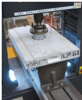
(c) 押し抜き試験状況
