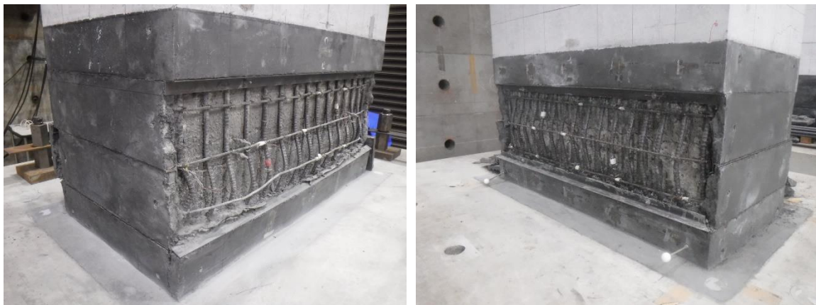
写真-4.4.50 実験終了後のベースプレートの損傷状態
