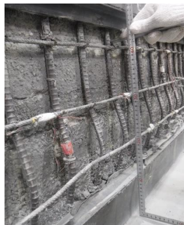
写真-4.4.74 はらみ出し長計測
