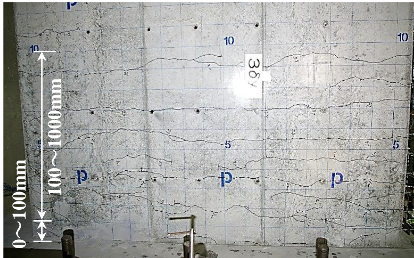
(a) 3\delta_y 載荷終了後の損傷状況
