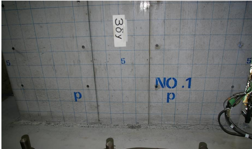
(a) 3\delta_y 载荷終了後の損傷状況
