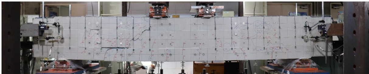
(c) CFP-2-J (CF パネル補強, 繊維目付量 200g/m 2 , 側面接合部)
