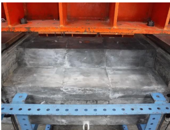
写真-4.4.19 等曲げ区間圧縮側の状況
