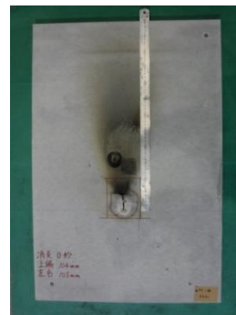
(d) 延焼性試験後の CF パネル
