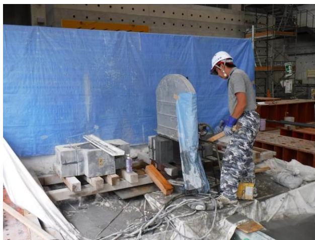
写真-4.3.5 供試体の切り出し状況
