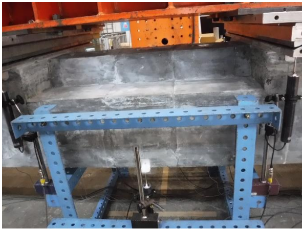
写真-4.4.22 等曲げ区間の状況
