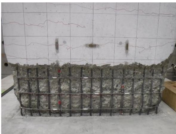
写真-4.4.61 実験終了後 負荷圧縮側
