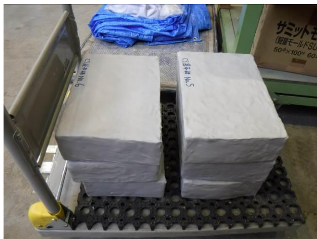
写真-4.3.6 浸漬前の供試体
