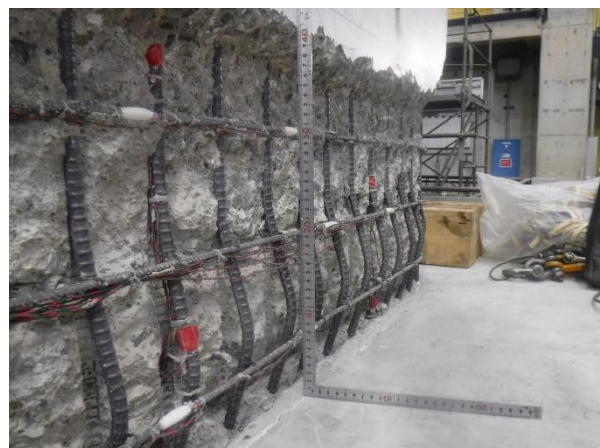
写真-4.4.62 はらみ出し長計測
