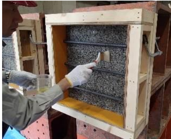
写真-4.3.2 プライマーの塗布
