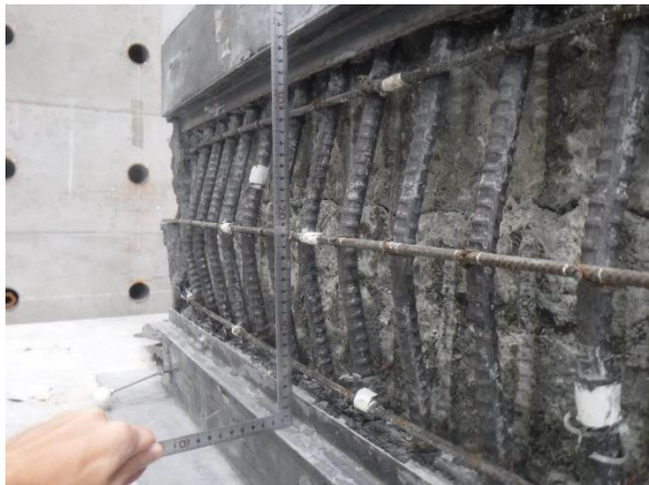
写真-4.4.86 はらみ出し長計測
