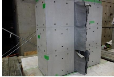
(5) CF パネル設置完了
