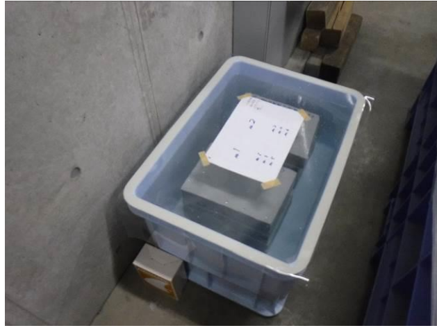
写真-4.3.7 塩水への浸漬状況
