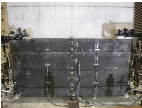
写真-4.4.67 +9δ, (限界状態 2) 圧縮側 基部から 2 段目の補強部に縦方向のひび割れ
