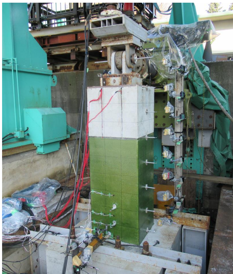
写真-3.4.1 荷重装置および供試体設置状況
