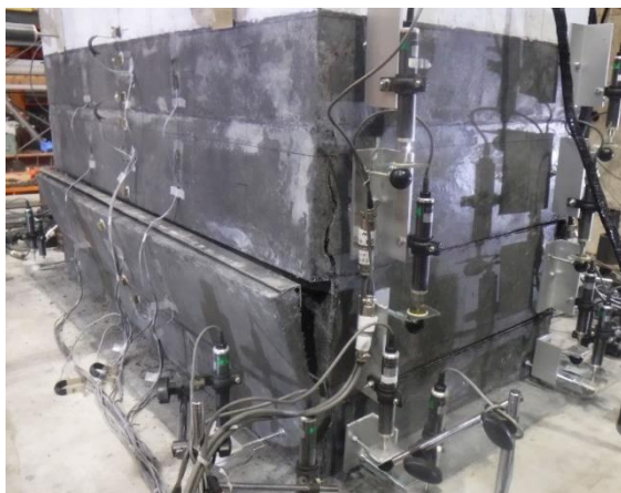
写真-4.4.43 +10 \delta_y - 3 回目 圧縮側柱基部
