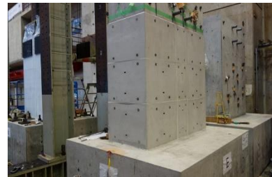
(12) CF パネル施工完了
