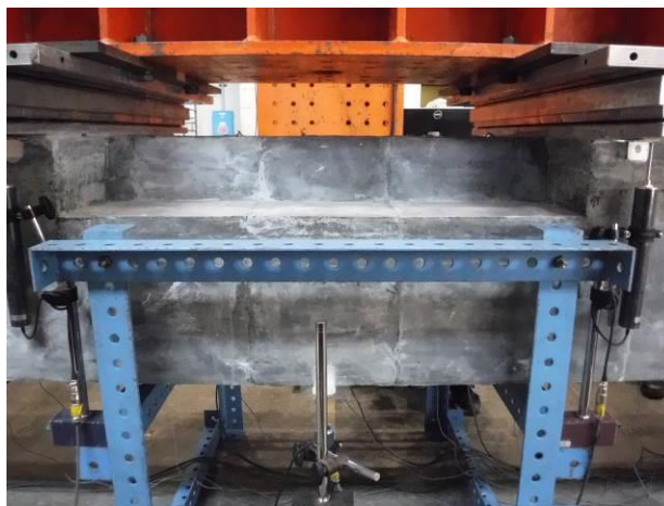
写真-4.4.6 等曲げ区間におけるひび割れ状況 (STEP4)
