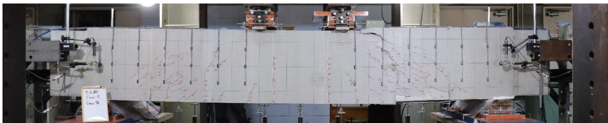
(e) CFP-2-N-UB (CF パネル補強, 繊維目付量 200g/m 2 , 側面一般部, 付着なし)
