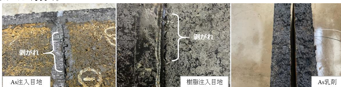
写真4 ホイールトラッキング負荷試験後の供試体
