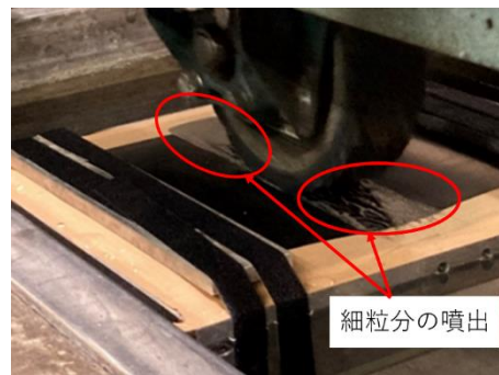
写真-4 ポンピング現象再現試験状況
