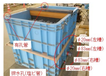
図3 有孔管、排水孔設置状況
