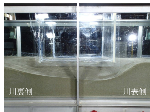
写真1 破壊後の状況例（ケース2）
