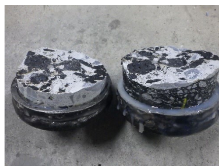
写真-3-12 試験後の供試体 (開発グース・基盤間)
