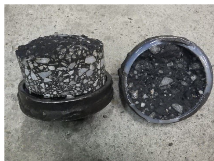
写真-3-13 試験後の供試体 (開発グース・表層間)
