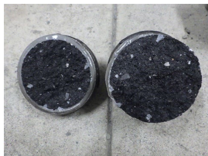
写真-4-13 基層表層試験後供試体
