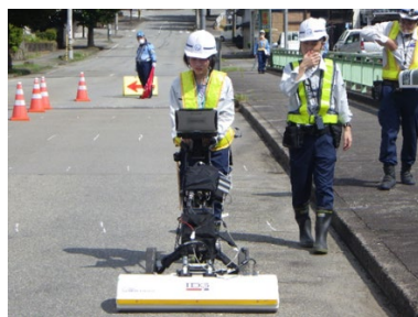
写真 1-3-4 カート式 電磁波レーダ
