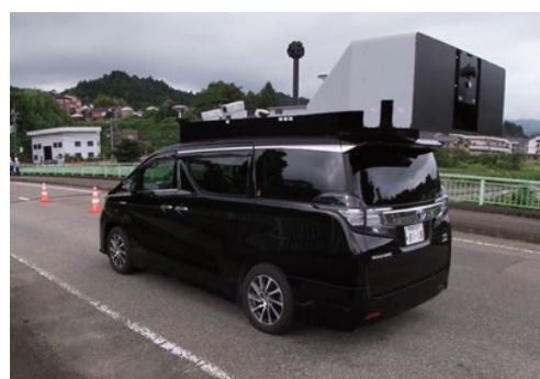
写真 1-3-7 MMS (Mobile Mapping System) 計測
