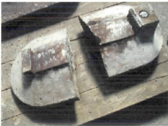
図 3-11-9 沓座モルタル内の空隙が原因で生じた変状の事例 27), 28)
