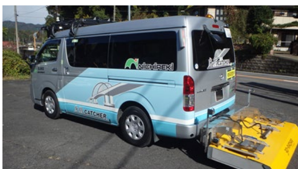
写真 1-3-6 車載式電磁波レーダ
