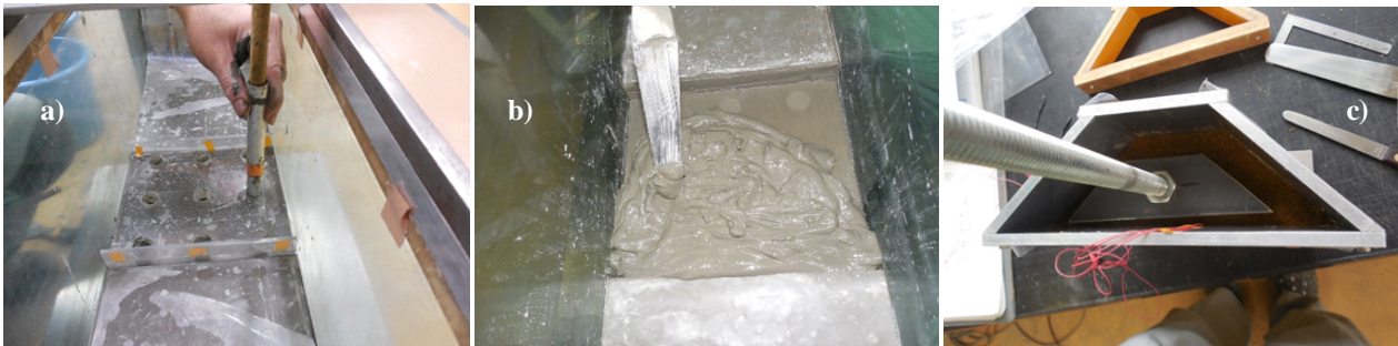
図-6 改良体の作成 (左: 深層改良体, 中: 浅層改良体) と盛土の作成 (右)
