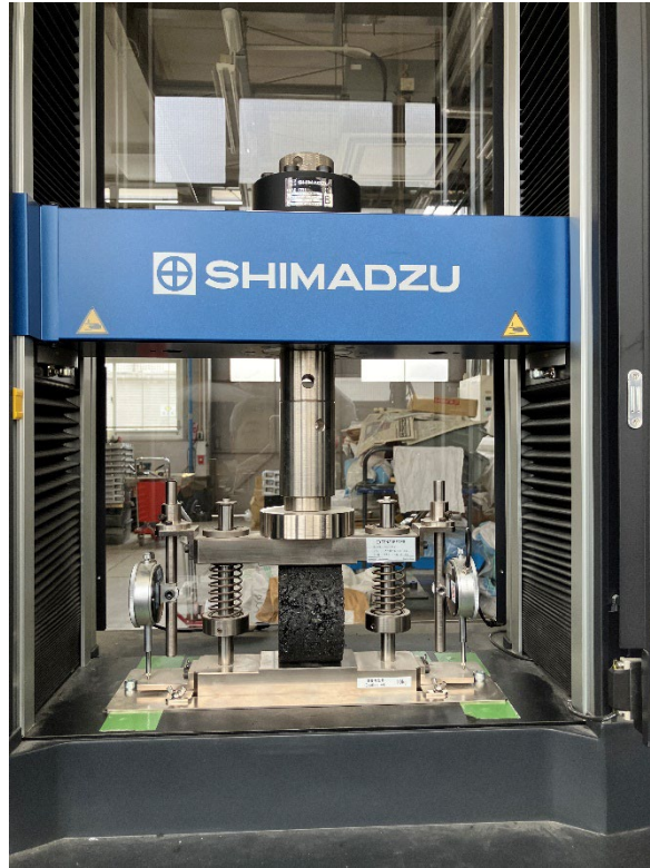
図 3-3-2 圧裂試験機：オートグラフ AG-8000（島津製作所）
