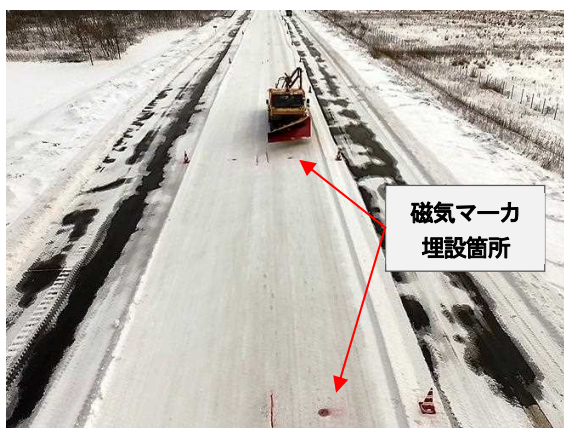
写真-14 自車位置測位実験（直線部）
