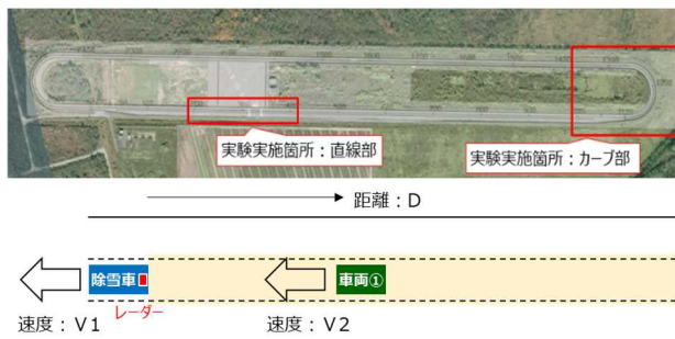
図-82 実験箇所平面図及び実験概略図
