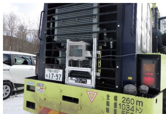
写真-54 ミリ波レーダ設置状況
