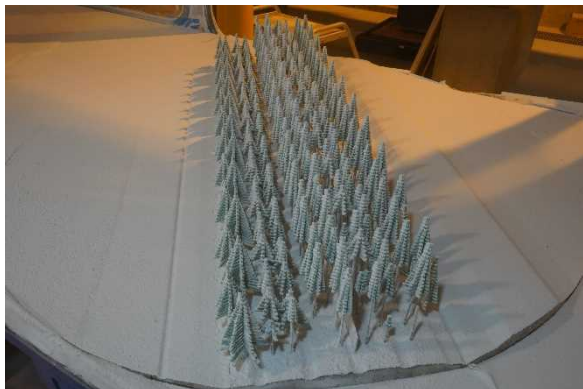
図-92 吹き溜まり状況（ネット柵有り）林帯前後
