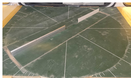
図-26 実験装置のターンテーブルと製作した防雪柵模型
