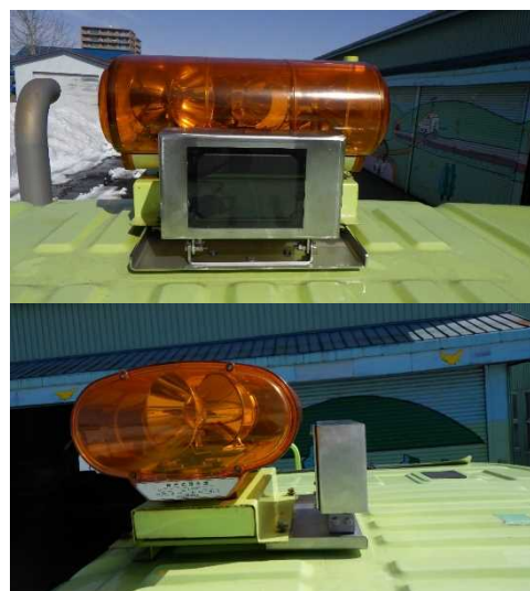
写真-53 ミリ波レーダ設置状況
