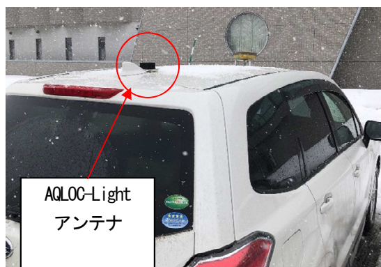
写真-22 アンテナ設置状況
