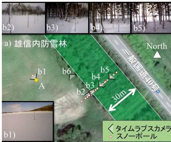
図-152 吹きだまり観測の概要図
