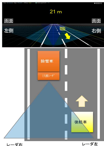
図-70 後方障害物探知ガイダンス表示イメージ
