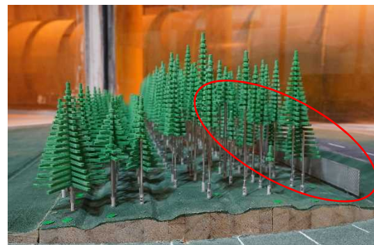
図-104 ネット柵林帯風下設置
