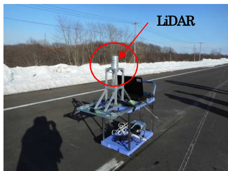
写真-8 LiDAR による自転車位置測定状況
