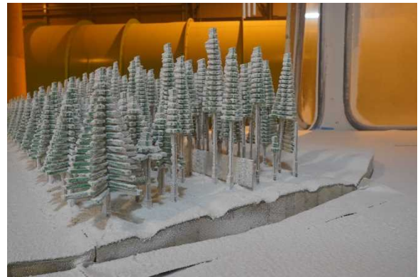
図-94 樹木模型に付着した模擬雪
