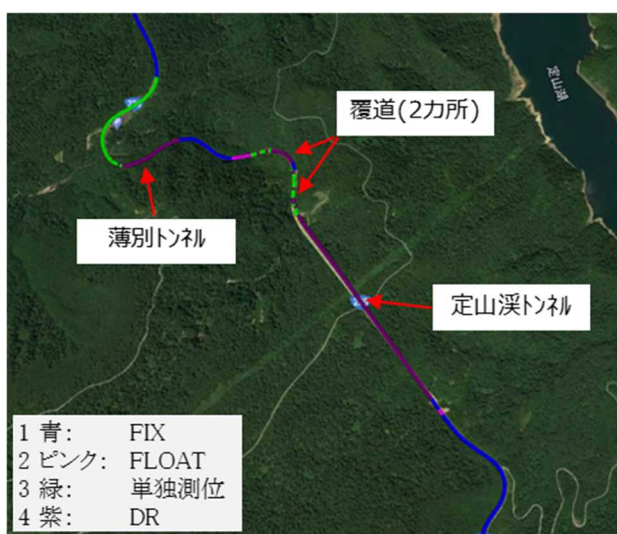
図-17 一般国道 230 号定山溪トンネル付近の受信状況
