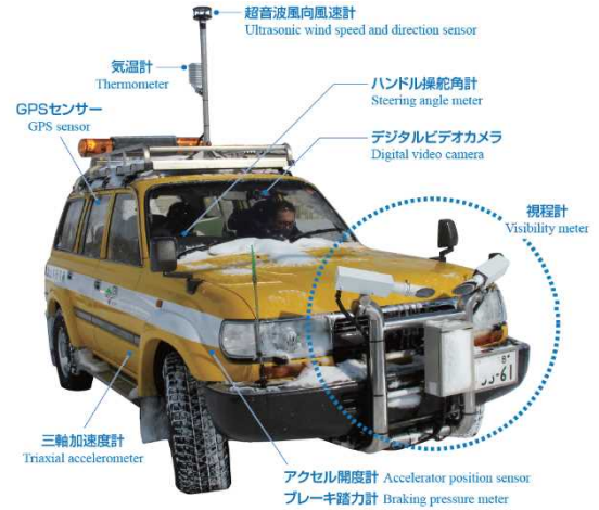
図-199 視程障害移動観測車の車載計測機器
