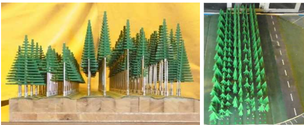
図-74 枯れ上り模型の側面と実験状況
