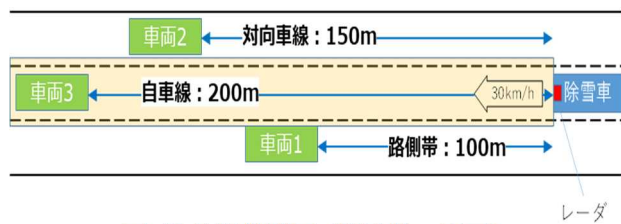
図-43 実験概略図 (障害物：車両)
