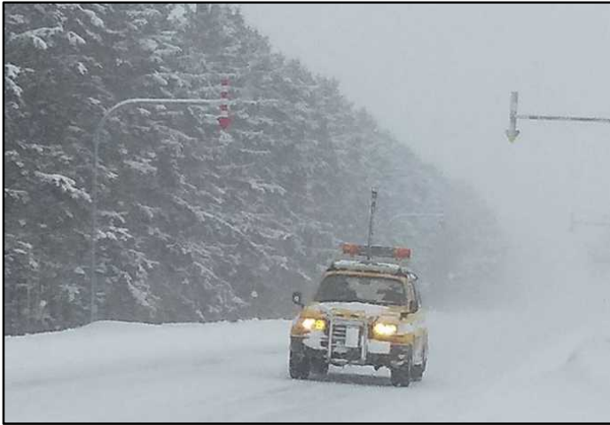
図-198 視程障害移動観測車の計測状況(令和3年2月3日)
