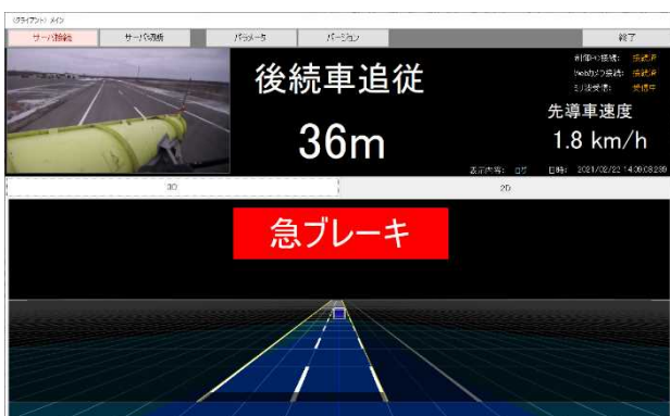
図-81 ガイダンス画面例（急ブレーキ判定時）
