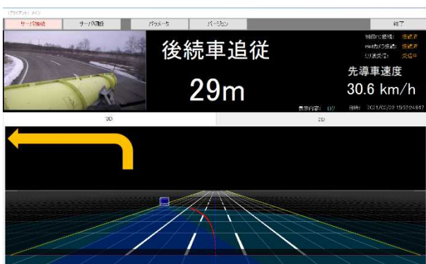
図-80 ガイダンス画面例（カーブ判定時）
