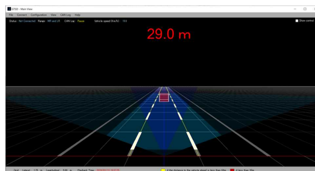
図-50 ガイダンス画面例 (注意 60m 警告 30m時_警告)
