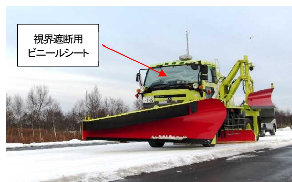
写真-18 実験状況（除雪機械外観）
