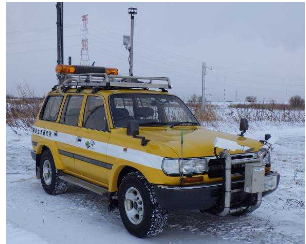
図-2 視程障害移動観測車
