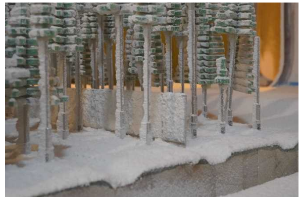
図-95 ネット柵に付着した模擬雪
