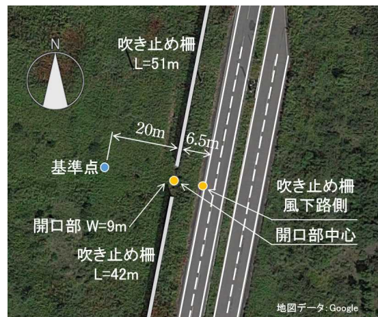
図-17 観測機器設置状況
