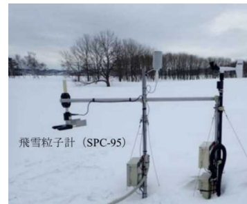
図-32 基準点 (No. 0) に設置した飛雪粒子計
