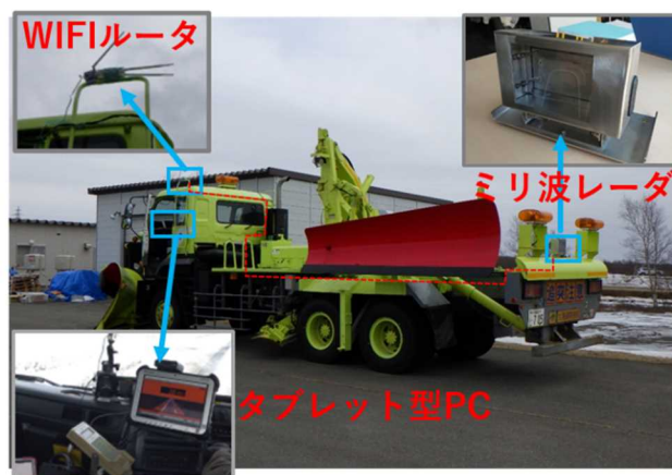
図-88 機器設置状況
