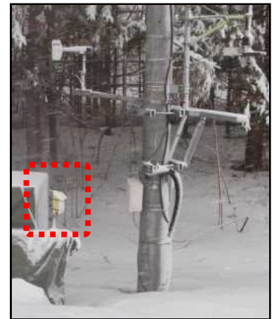
図-210 雪が付着した定点カメラ
