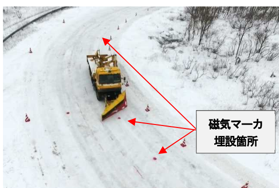
写真-15 自車位置測位実験（曲線部）
