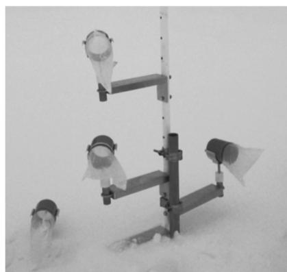
図-8 筒型ネット式吹雪計
