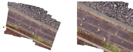
(b) Inspire2+X5sによる2019年撮影写真から作成した鉛直オルソモザイク画像とオルソ切抜画像
