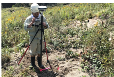
図-3.4 標定点の現地測量
