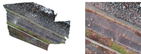
(a) Phantom4Proによる2017年撮影写真から作成した鉛直オルソモザイク画像とオルソ切抜画像
