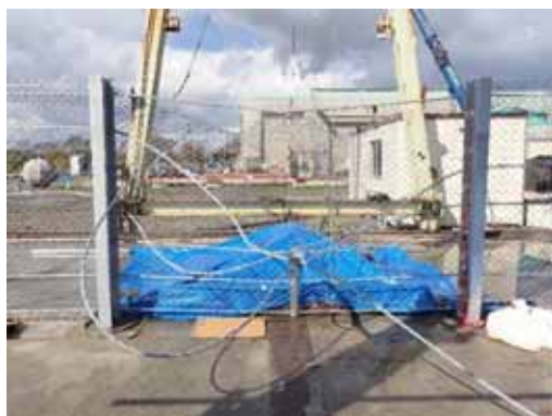
(a) 間隔保持材の車道側への飛散
