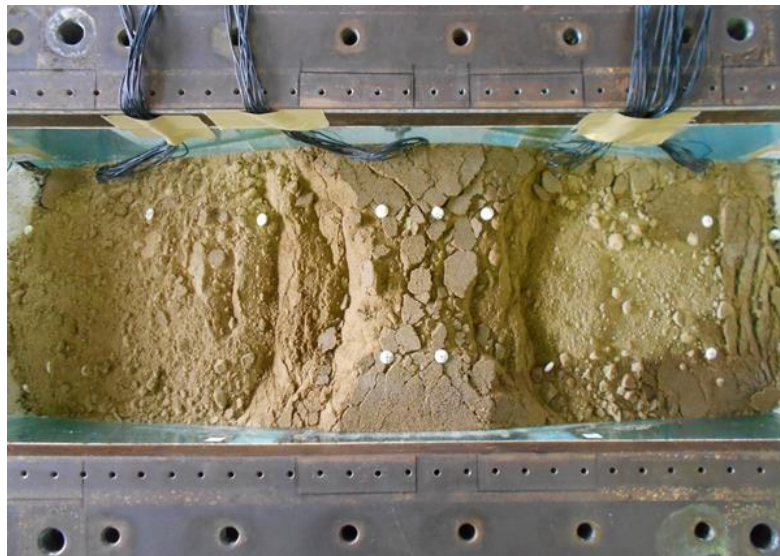
写真 4.3.2 ケース 3-2 における実験後の模型の状態 (堤体真上から撮影)
