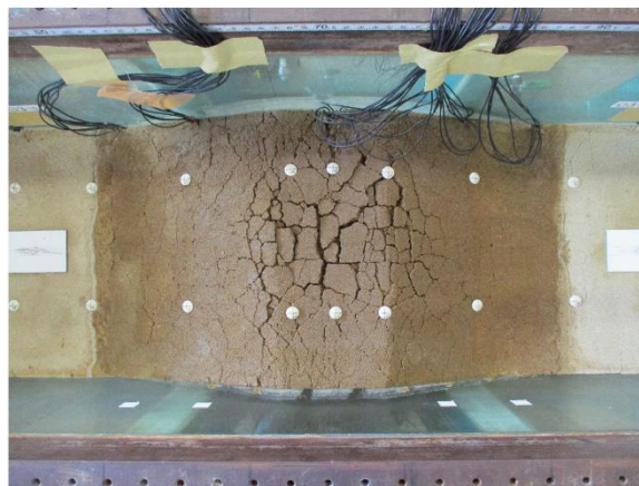
写真 5.3.5 ケース 4-3 における実験後の模型の状態 (堤体真上から撮影)
