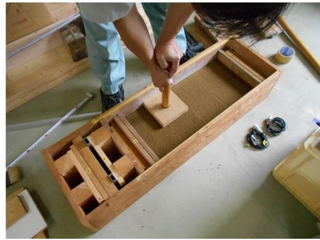
(g-1) 堤体の締固め状況
