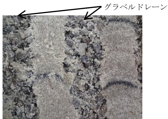
写真 4.3.3 水圧計設置高付近の模型開削状況
