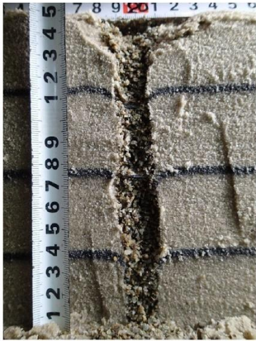
(a) 左ドレーン（ドレーン径 1.5m）
