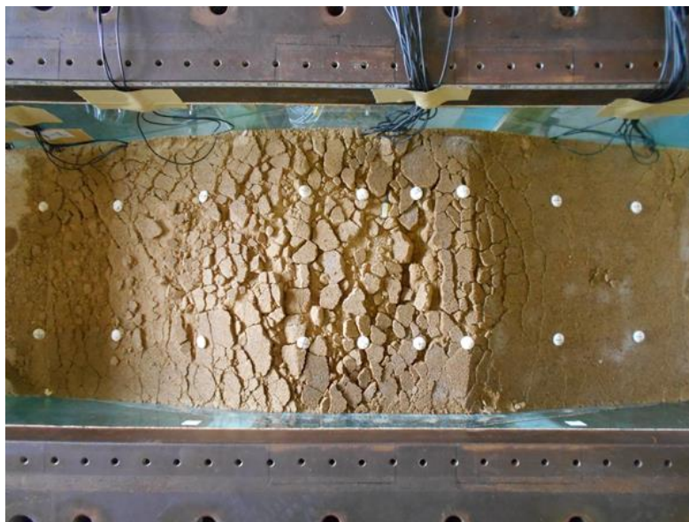
写真 4.3.1 ケース 3-1 における実験後の模型の状態 (堤体真上から撮影)
