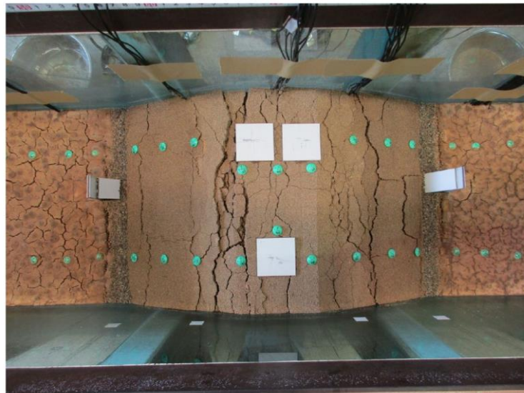
写真 2.3.4 ケース 1-2 における実験後の模型の状態 (堤体真上から撮影)
