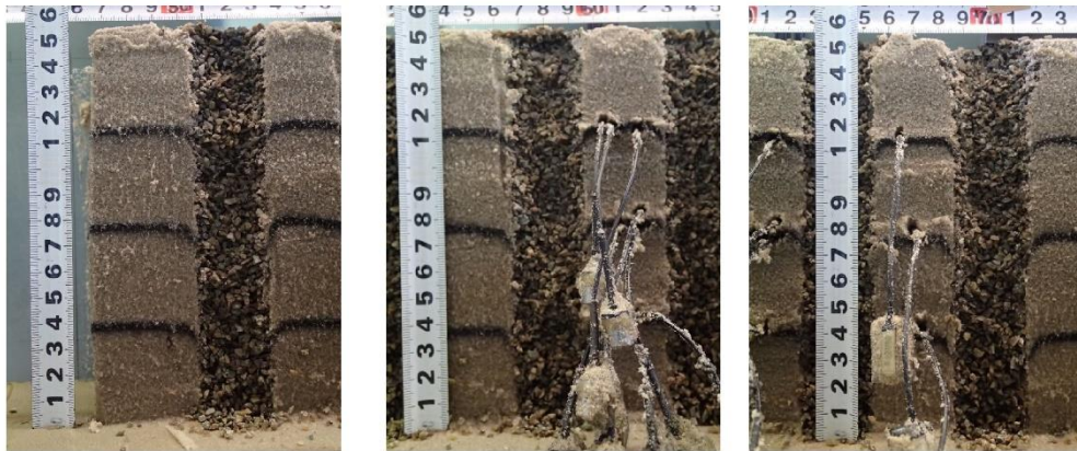
(b) 中央ドレーン（ドレーン径 1.5m）（写真中のケーブルは加速度計等）
