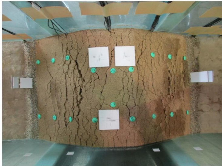
写真 2.3.6 ケース 1-3 における実験後の模型の状態（堤体真上から撮影）
