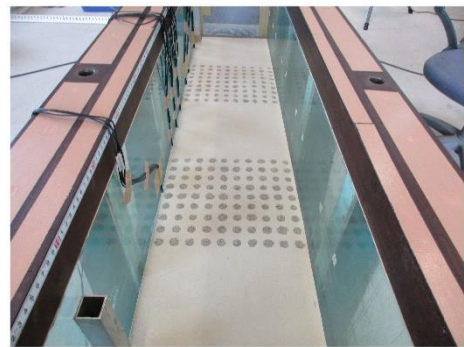
(e-5) ドレーン完成状況
