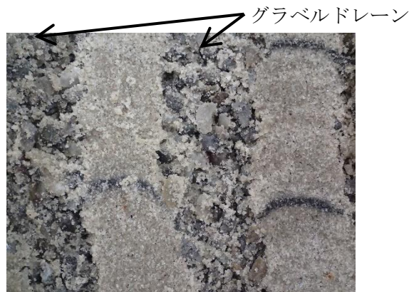
写真 4.3.3 水圧計設置高付近の模型開削状況 (再掲)
