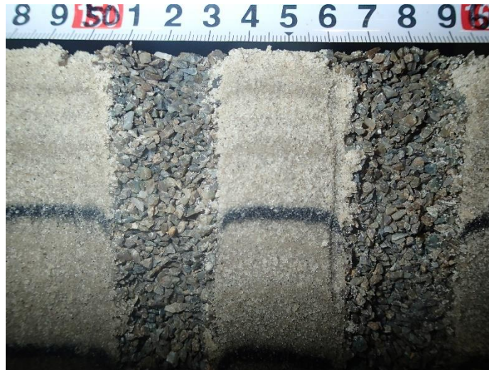
写真 3.4.1 ケース 2-4 における実験後の中央ドレーン（ドレーン径 1.5m）の開削断面
