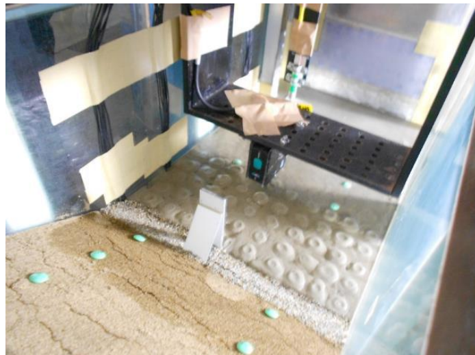
写真 2.3.7 実験後の水平地盤面（ドレーン箇所）の状況（再掲）
