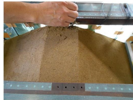
(g-3) 堤体側面の間詰め状況
