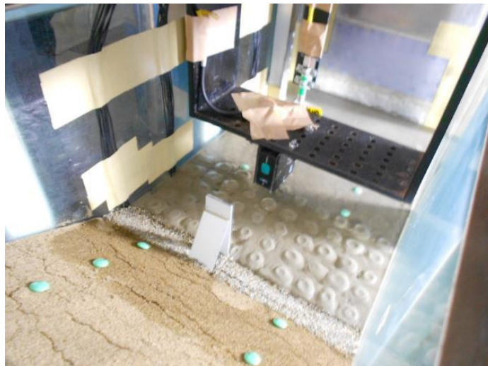
写真 2.3.7 実験後の水平地盤面（ドレーン箇所）の状況
