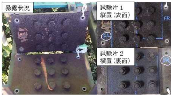
写真-1 試験片 (田園部で36年暴露)
