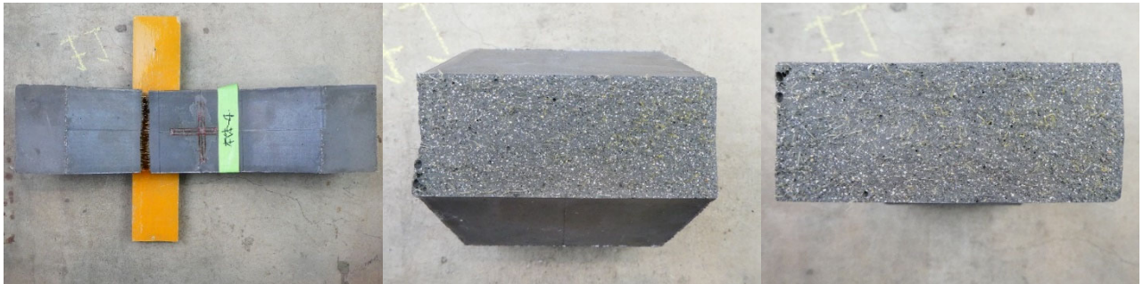
(b)床版-4 の側面と破断面
