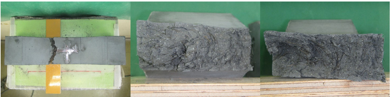
(c)はり-5 の側面と破断面
