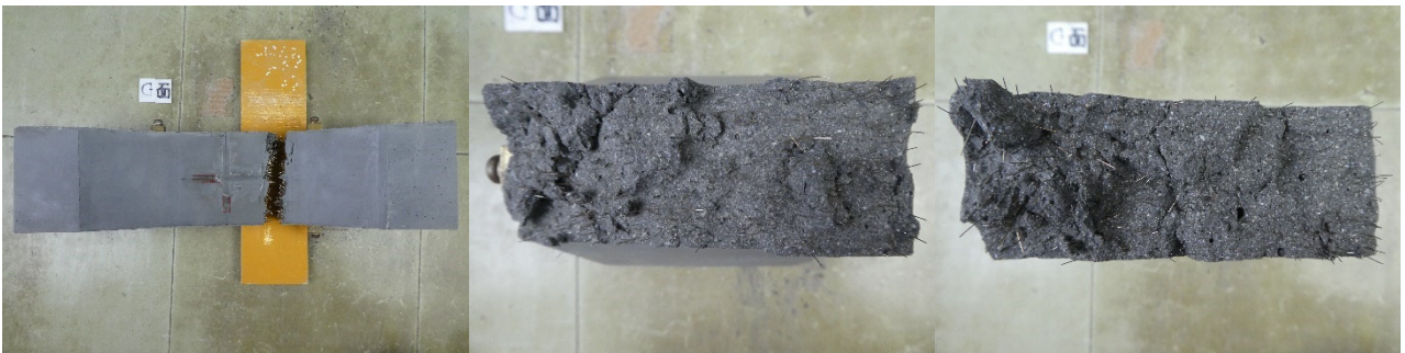
(c)はり-2 の側面と破断面
