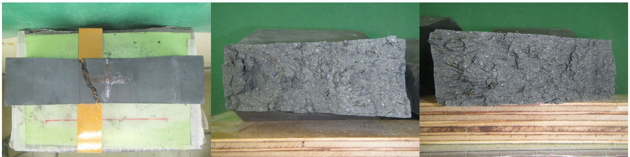
(d)はり (間) -6 の側面と破断面
