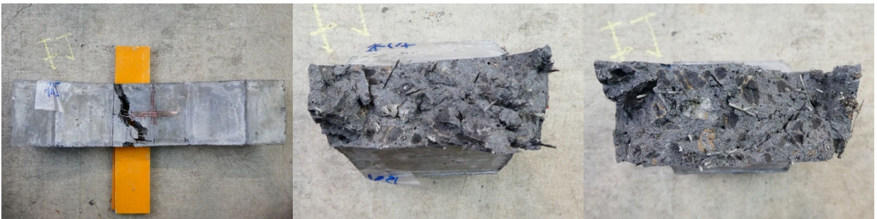
(c)床版-2 の側面と破断面
