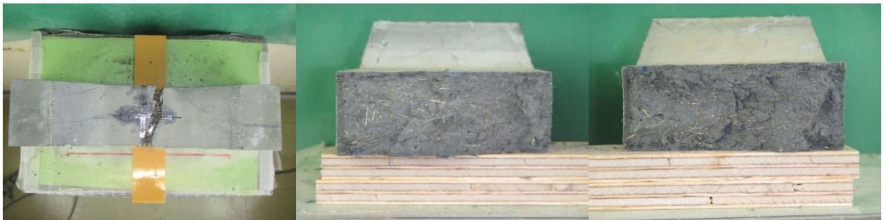
(d)JT-6 の側面と破断面
