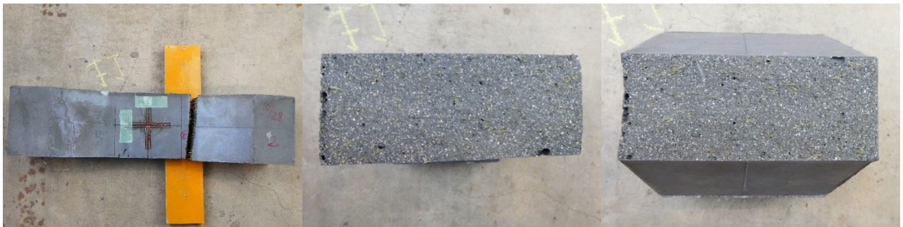
(c)はり-2 の側面と破断面
