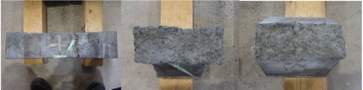
(b) PCa-1 の側面と破断面
