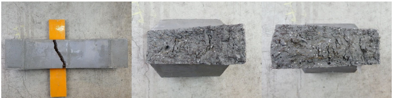
(d)床版(間) -6 の側面と破断面
