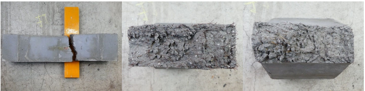
(c)床版 (間) -2 の側面と破断面
