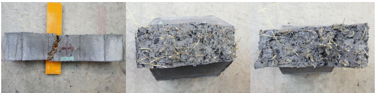
(d)はり (間) -3 の側面と破断面
