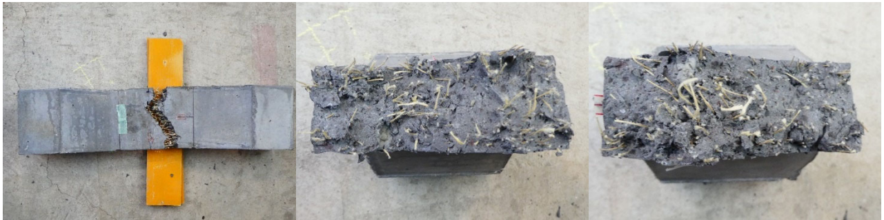
(b)はり (間) -1 の側面と破断面
