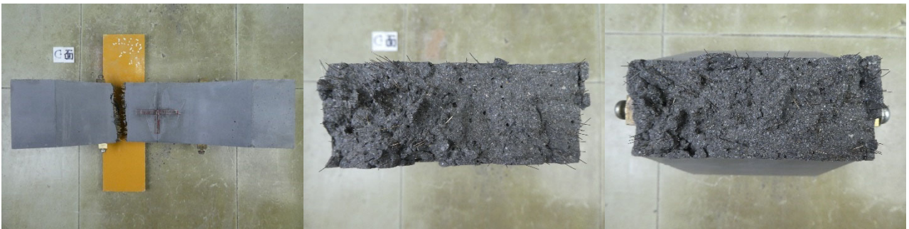
(d)はり-3 の側面と破断面
