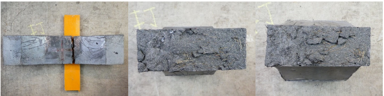
(d)補修材-3 の側面と破断面
