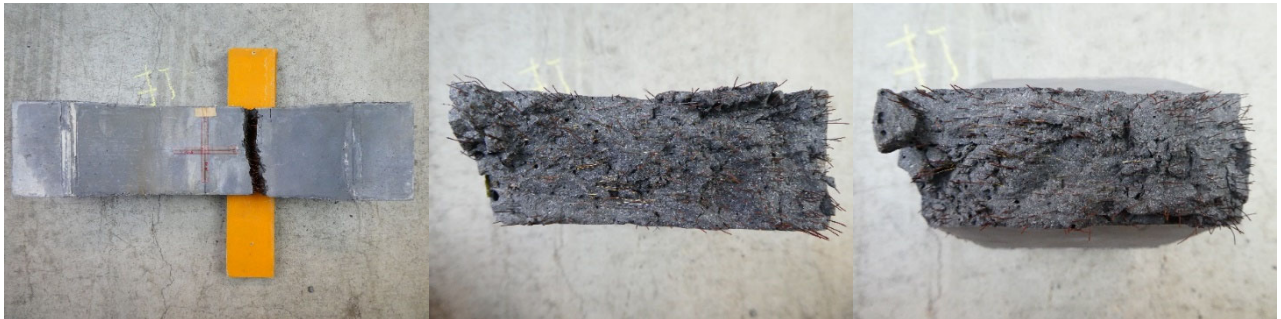
(b)床版(大)-1の側面と破断面
