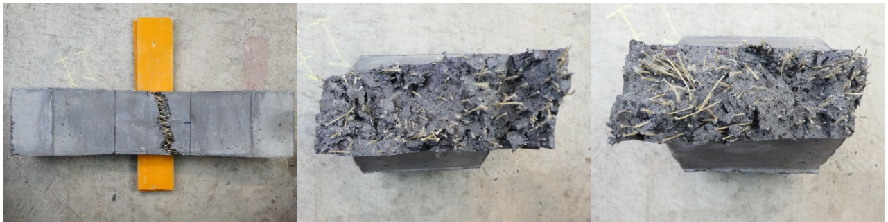
(b)床版(間) -4 の側面と破断面
