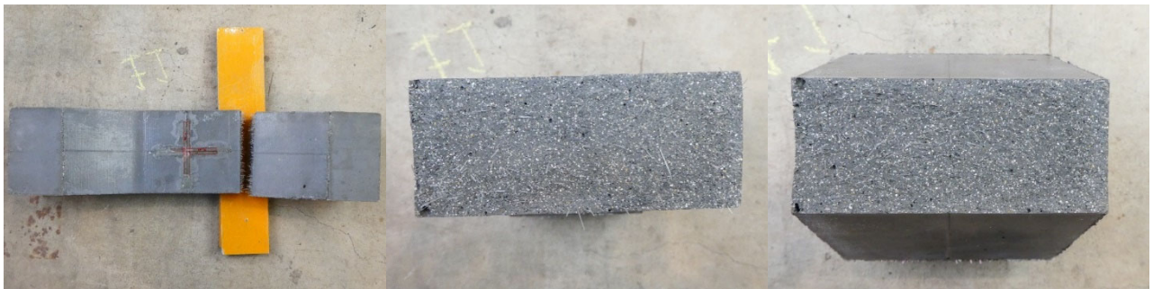
(c)床版 (間) -5 の側面と破断面
