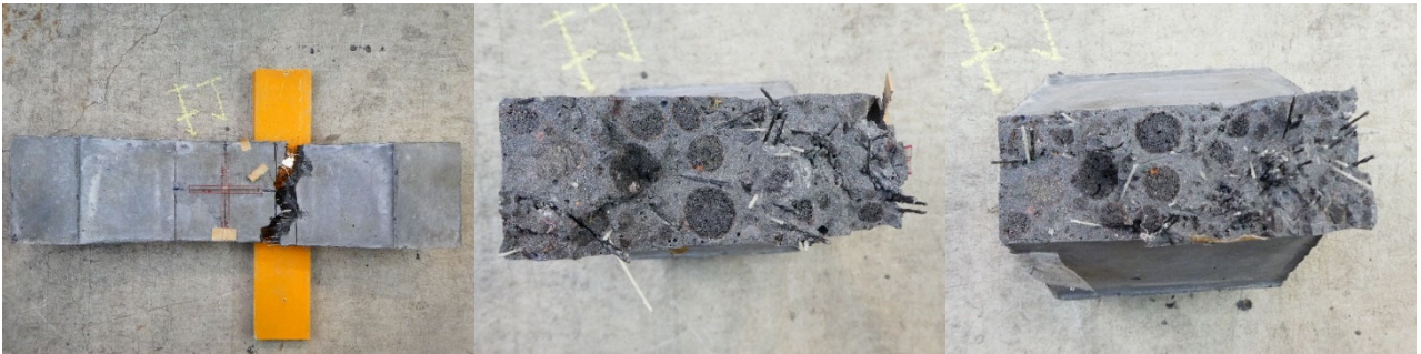
(b)床版-1 の側面と破断面
