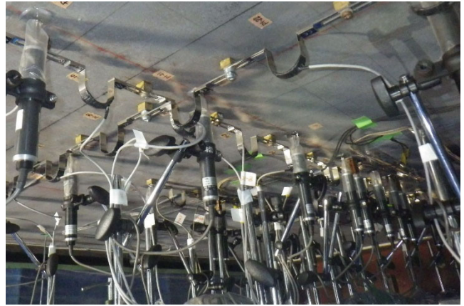
(a) 床版下面の鉛直変位計とパイ型変位計の設置状況（版全体の挙動）
