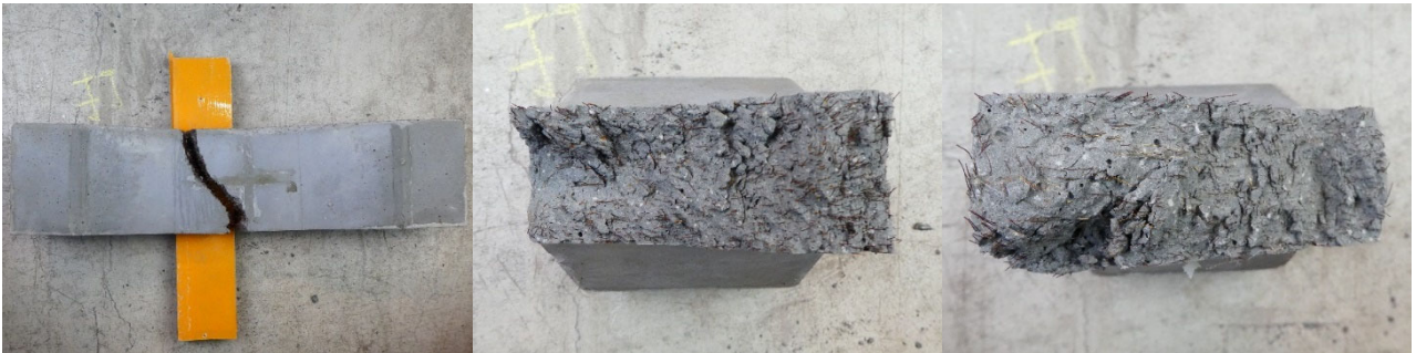
(b)床版 (間) -1 の側面と破断面
