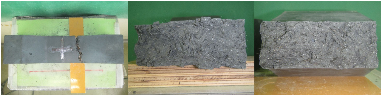
(b)はり (間) -4 の側面と破断面
