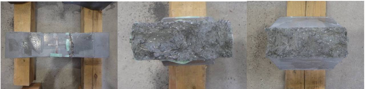
(c) 接合部-2 の側面と破断面
