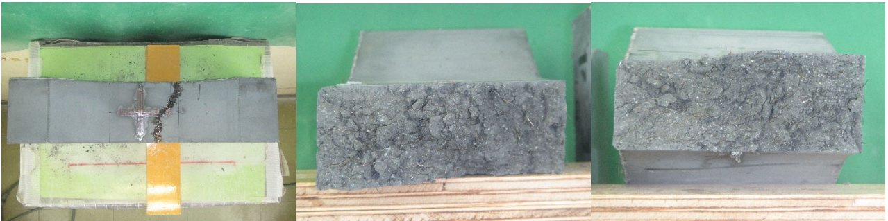
(b)はり-4 の側面と破断面
