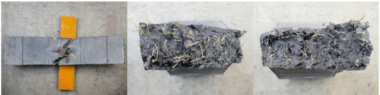
(d)床版 (間) -3 の側面と破断面
