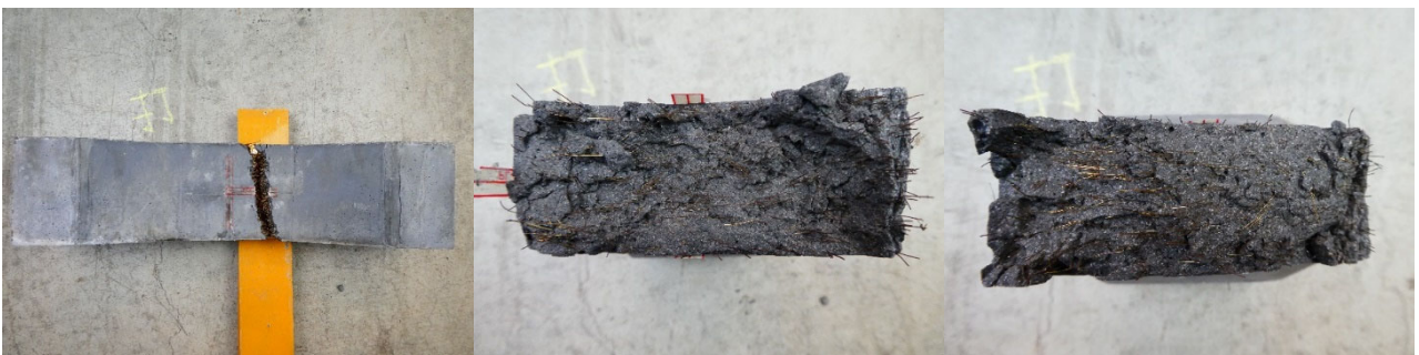
(d)床版 (小) -6 の側面と破断面
