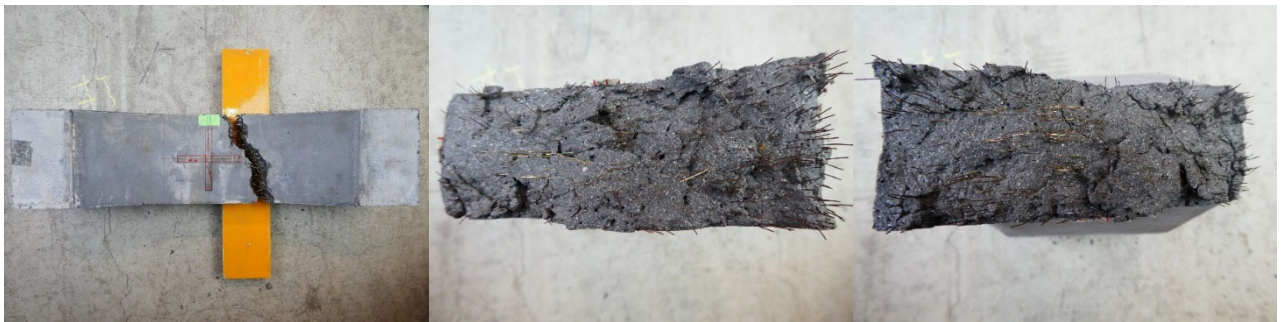
(c)床版 (大) -5 の側面と破断面
