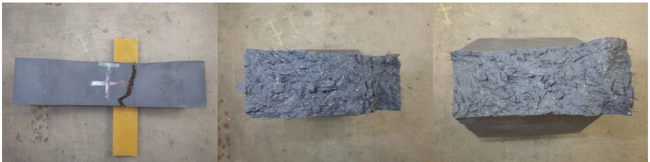
(d)はり (間) -3 の側面と破断面
