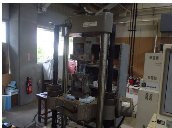
図-3 直接引張試験状況
