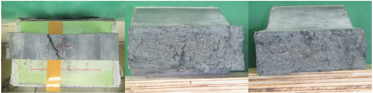
(b)hari-4 の側面と破断面
