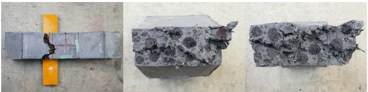
(d)はり-3 の側面と破断面
