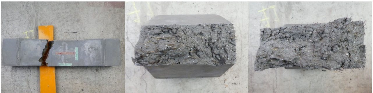
(b)はり (間) -1 の側面と破断面
