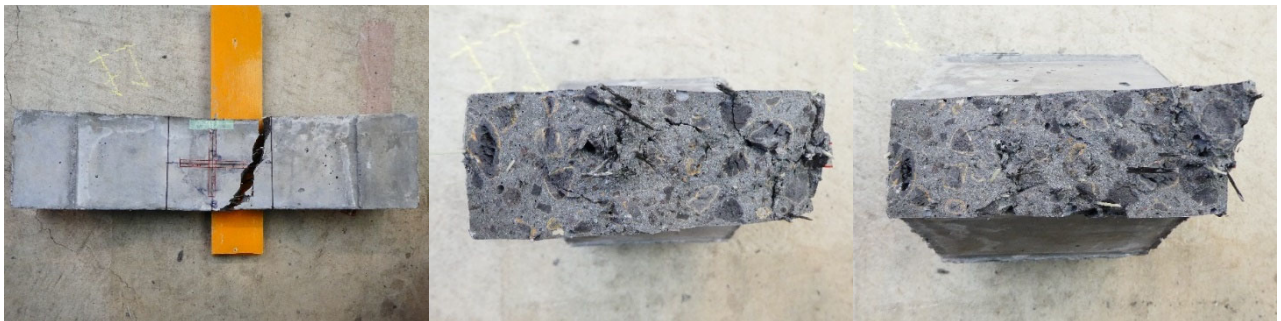
(b)はり-1 の側面と破断面
