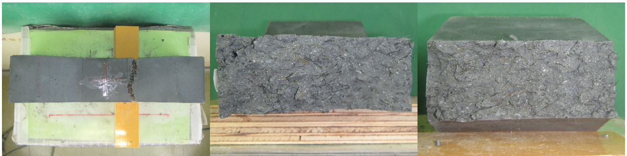
(c)はり (間) -5 の側面と破断面
