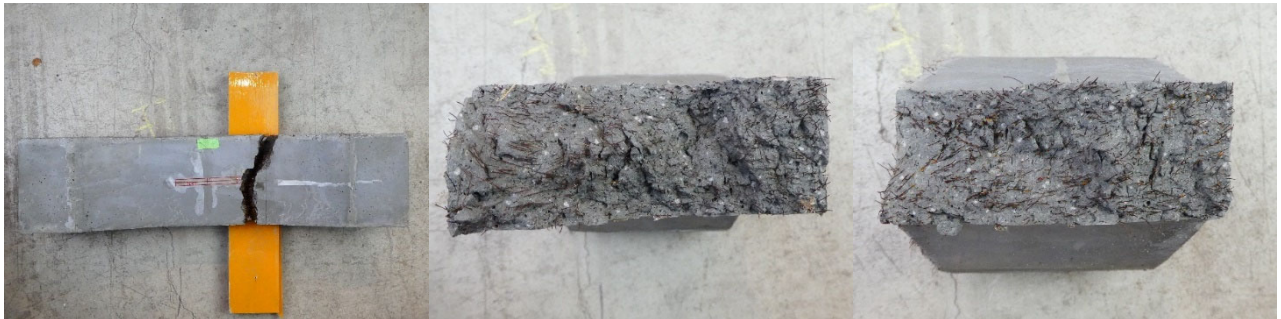
(b)床版(間) -4 の側面と破断面
