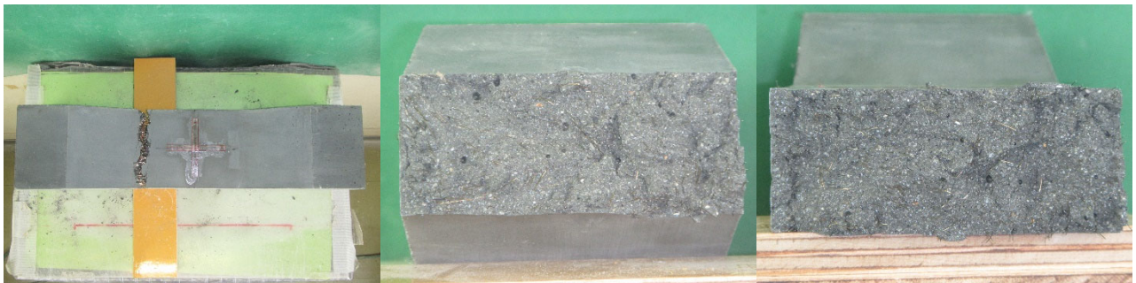
(c)補修材-5 の側面と破断面
