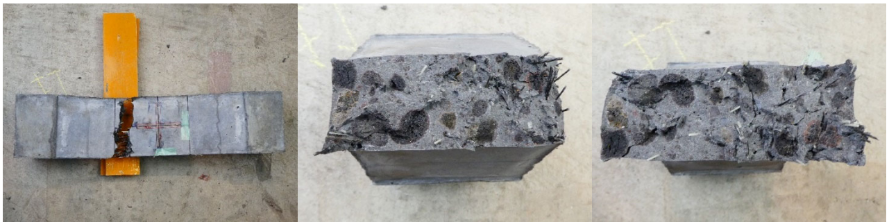
(c)はり-2 の側面と破断面
