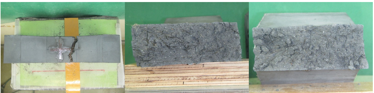
(d)はり-6 の側面と破断面
