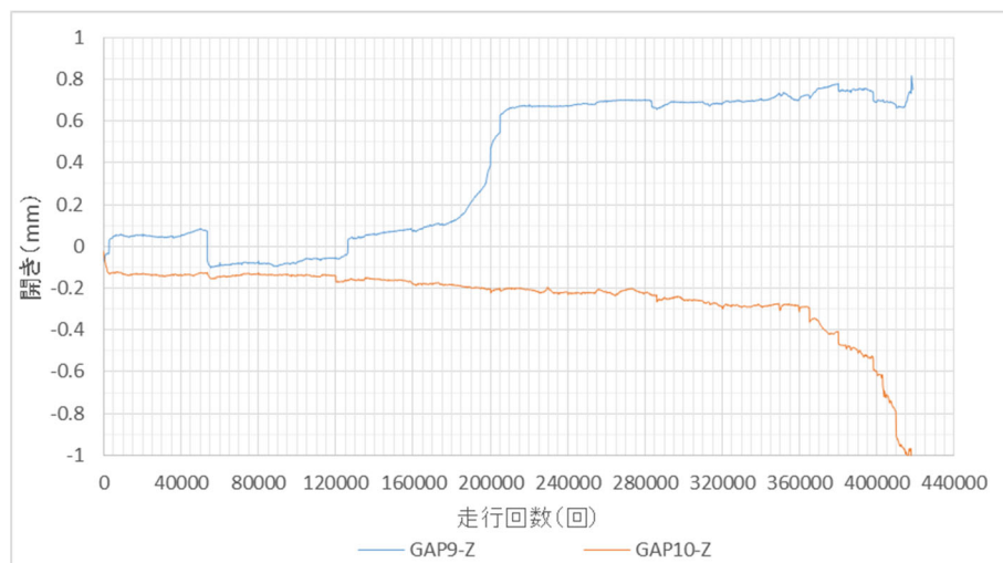
図-1.5.1.11 ずれセンサ変位（輪走行方向, CL-354mm 上面, 開き）(MM データ, 最大値)
