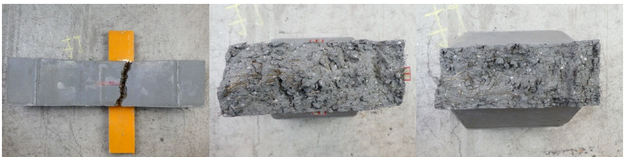
(c)はり (間) -2 の側面と破断面
