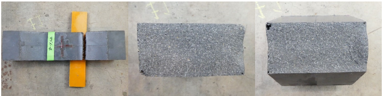
(b)床版 (間) -4 の側面と破断面
