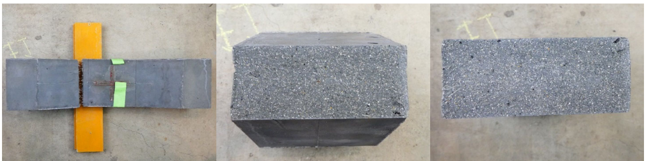
(d)床版-6 の側面と破断面
