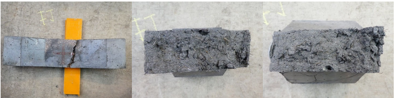
(c)補修材-2 の側面と破断面
