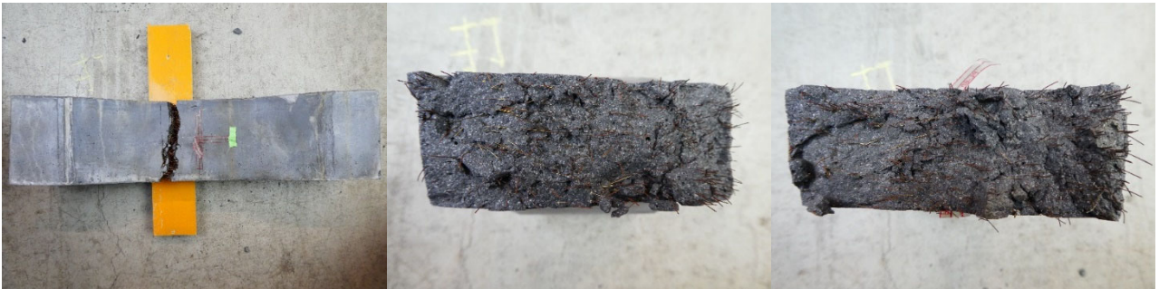
(b)床版 (小) -4 の側面と破断面
