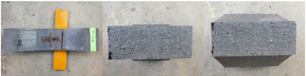
(d)床版 (間) -6 の側面と破断面
