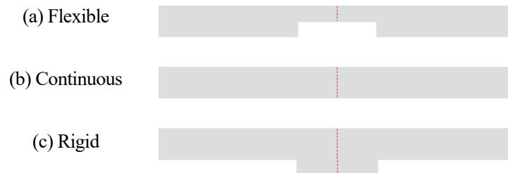
図-2.4.1 接合構造の剛性による分類 (プレキャスト部との相対差のイメージ)
