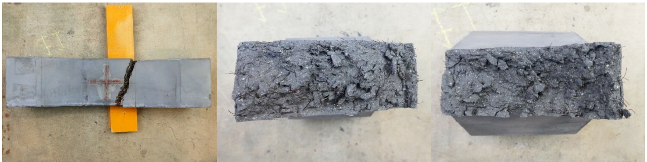
(c)はり-2 の側面と破断面
