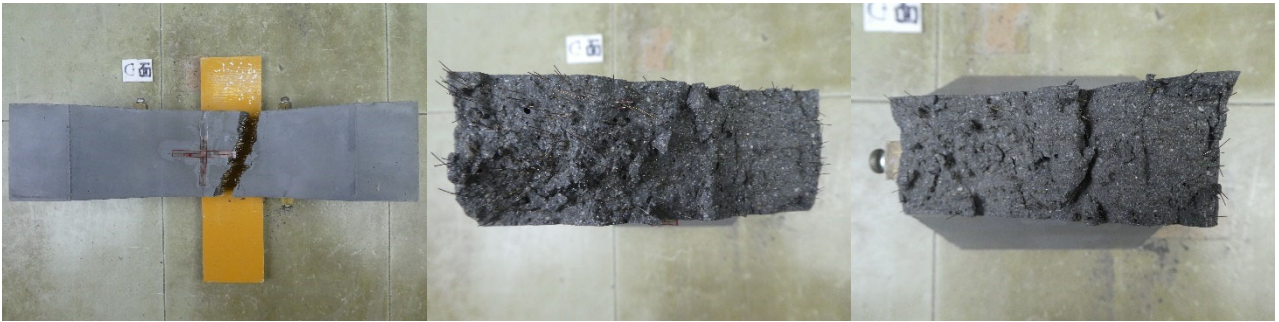
(b)はり-1 の側面と破断面
