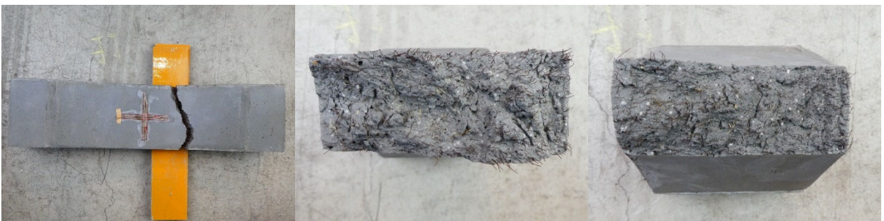
(d)床版 (間) -3 の側面と破断面
