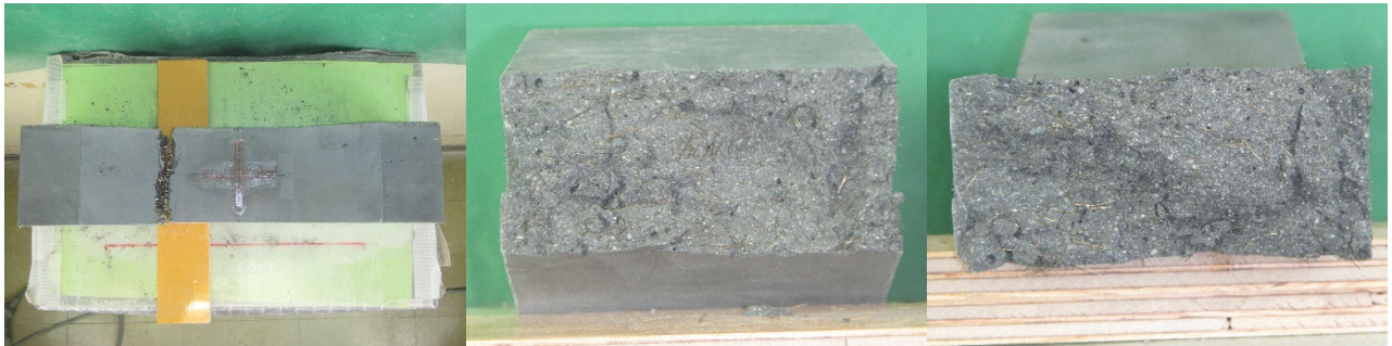
(b)補修材-4 の側面と破断面
