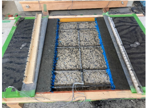
図-1.2.5.3 エポキシ接着剤の塗布状況 (KJ)
