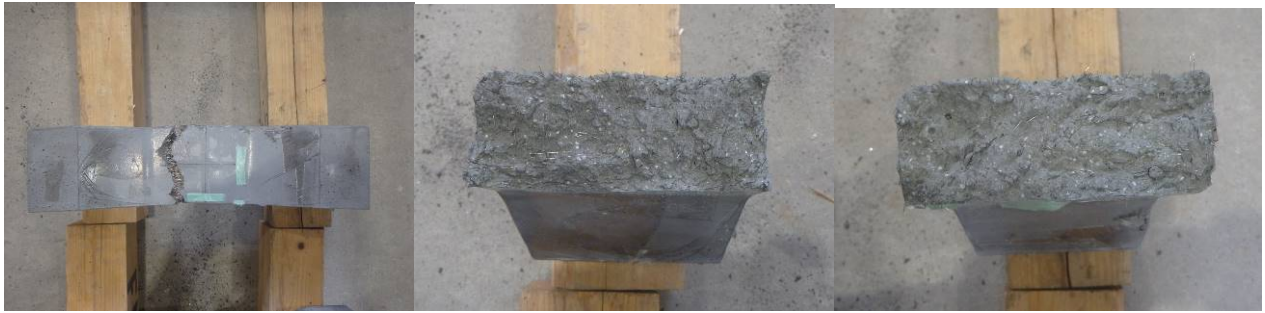
(b) 接合部-1 の側面と破断面
