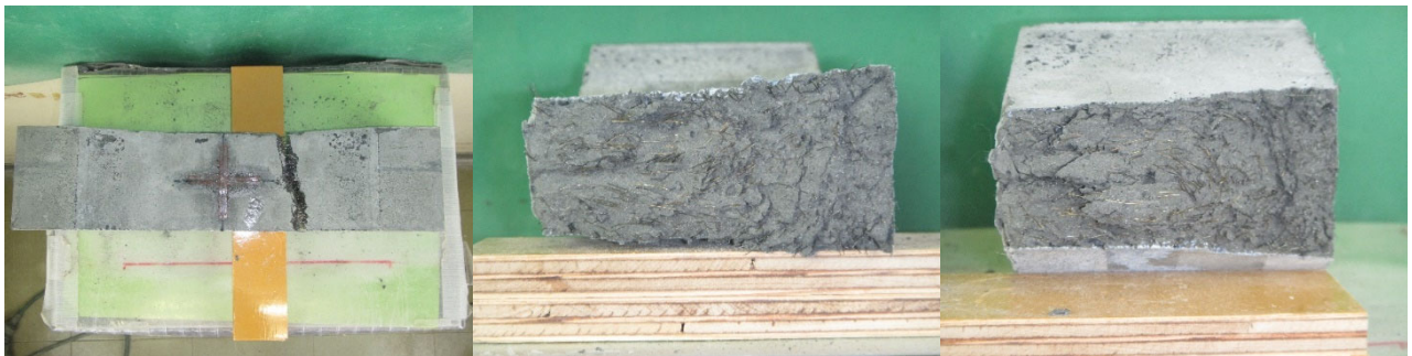
(d)JT-3 の側面と破断面
