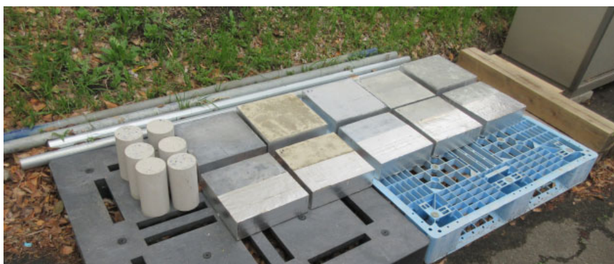
図-1.2.7.1 暴露試験状況（上：床版模擬試験体，下：平板と円柱）
