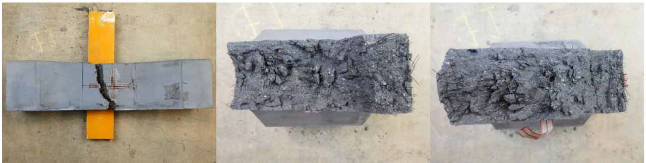
(d)はり-3 の側面と破断面
