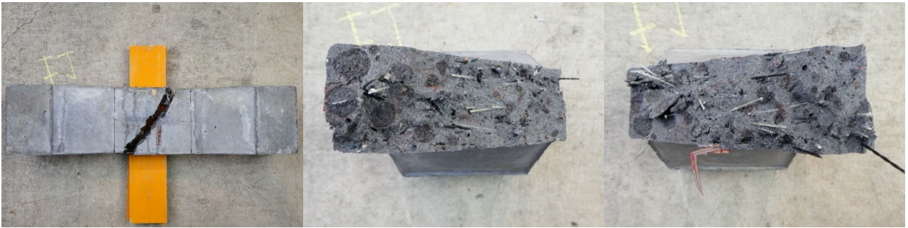
(b)床版-4 の側面と破断面
