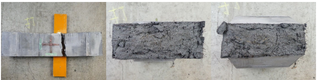
(c)はり-2 の側面と破断面
