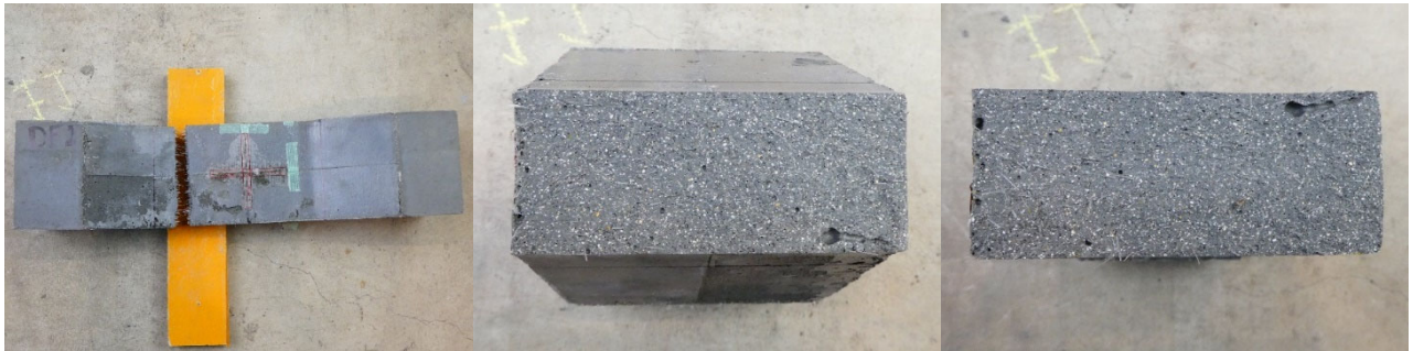
(b)はり (間) -1 の側面と破断面
