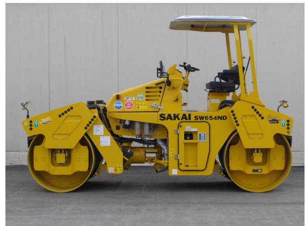
写真-4 水平振動ローラ (7t 級) になることがわかる。また、試験施工後採取した供試
