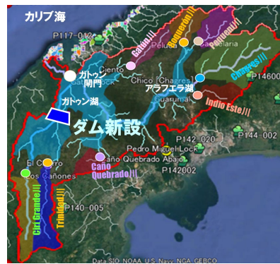
図-37 Ciri Grande 川と Trinidad 川との合流地点へのダムの新設
