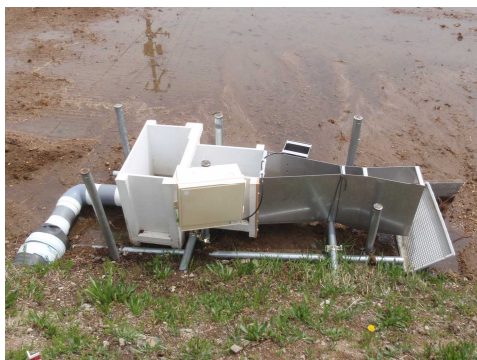
写真-1 パーシャルフリューム
