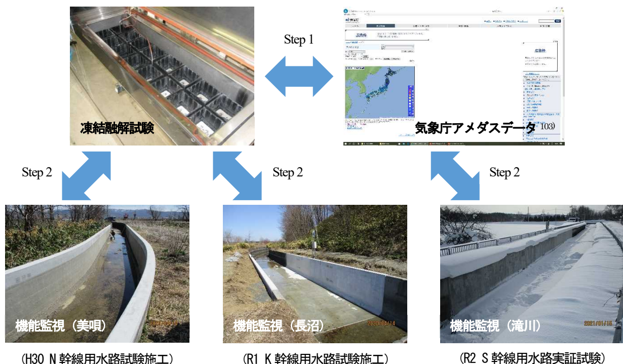
図-64 耐用年数の試算のイメージ（機能監視結果（現地温度データ）を用いた試算精度の向上）
