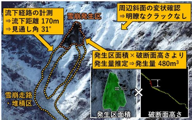
図-3 点群データから確認した雪崩の諸元
