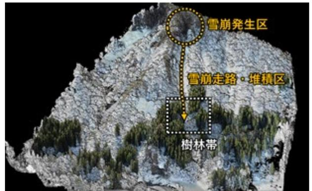
図-4 レーザ測量により作成した 3 次元点群データ
