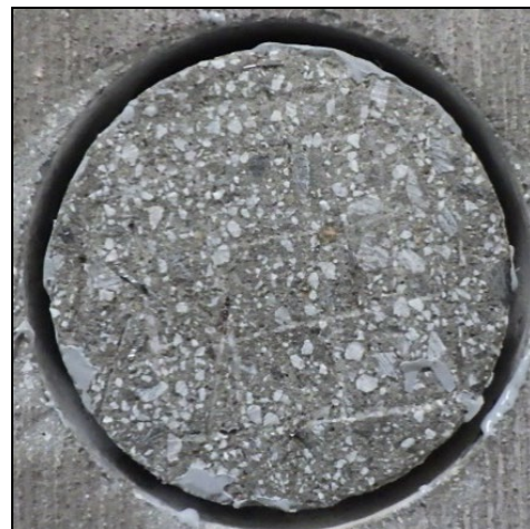
(d) No. 4 ( \phi 100 ) (左側：コア, 右側：鋼床版) 治具用接着剤での破壊
