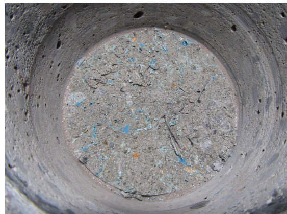
(c) No. 6 (左側：コア, 右側：鋼板) (材料破壊および凝集破壊)
