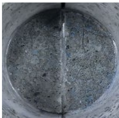
(c) ケース 2 STEP1 No. 3 (材料破壊)
