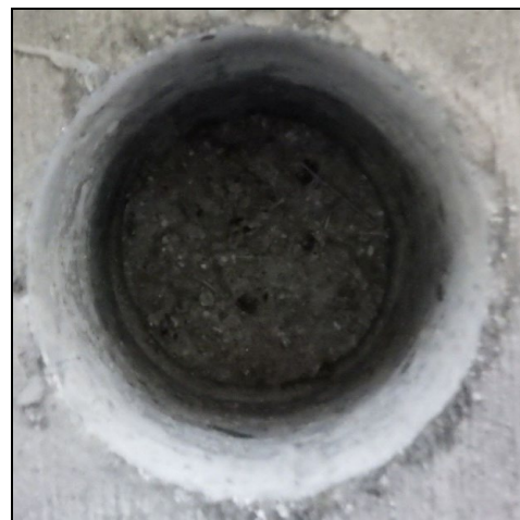
(h) No. 8 (φ80) (左側：コア, 右側：鋼床版) SFRC 舗装材料破壊
