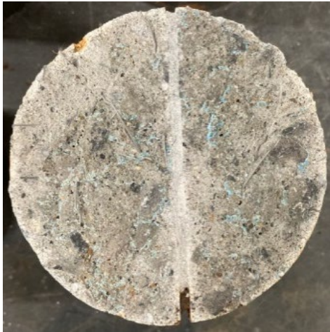
(a) ケース 3 STEP2 No. 1 (材料破壊)
