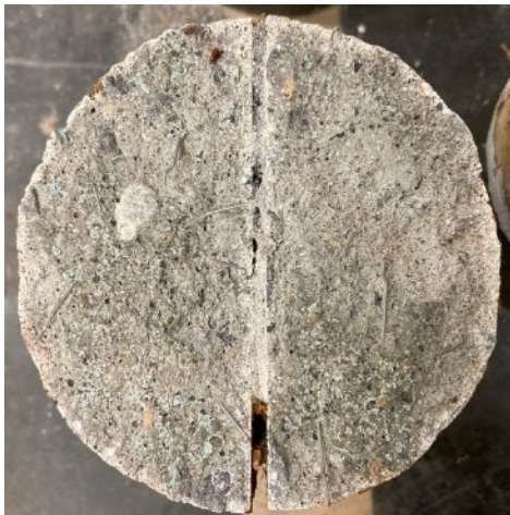
(b) ケース 3 STEP2 No. 2 (材料破壊)
