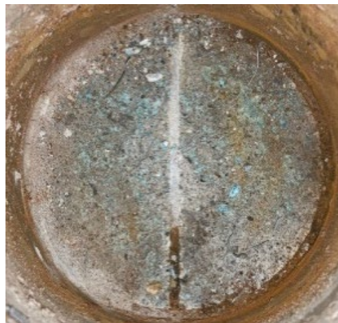
(c) ケース 3 STEP1 No. 3 (材料破壊)
