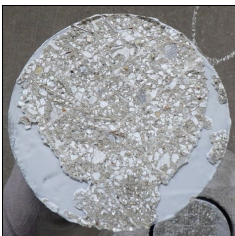
(e) No. 5 ( \phi 100 ) (左側：コア, 右側：鋼床版) 治具用接着剤での破壊
