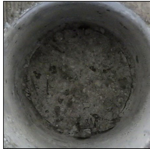
(f) No. 6 (φ80) (左側：コア, 右側：鋼床版) SFRC 舗装材料破壊
