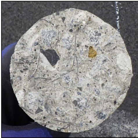
(c) No. 13 (φ80) (左側：コア, 右側：鋼床版) SFRC 舗装材料破壊
