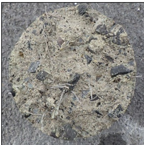
(e) No. 15 (φ80) (左側：コア, 右側：鋼床版) SFRC 舗装材料破壊
