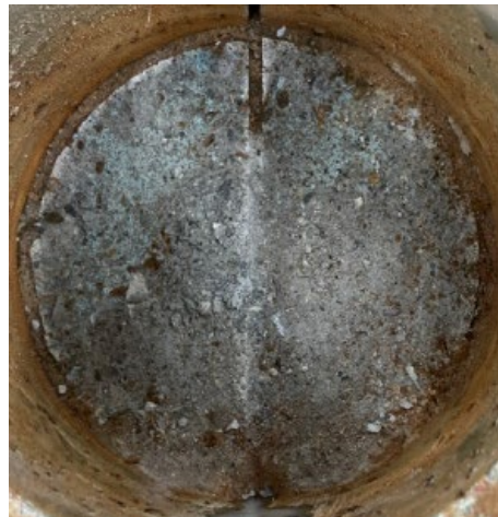
(b) ケース 3 STEP2 No. 2 (材料破壊)
