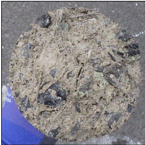
(d) No. 14 (φ80) (左側：コア, 右側：鋼床版) SFRC 舗装材料破壊
