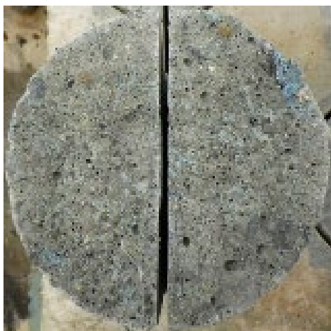
(a) ケース 2 STEP1 No. 1 (材料破壊)
