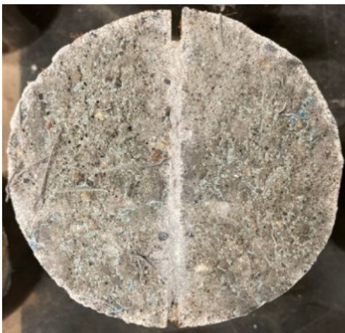
(c) ケース 3 STEP2 No. 3 (材料破壊)
