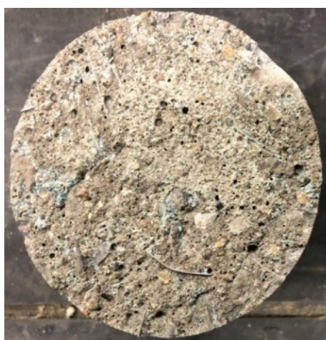
(c) ケース 1 STEP1 No. 3 (材料破壊)
