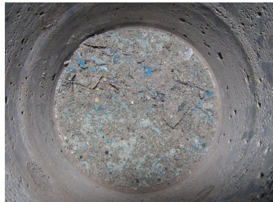
(b) No. 5 (左側：コア, 右側：鋼板) (材料破壊および凝集破壊)
