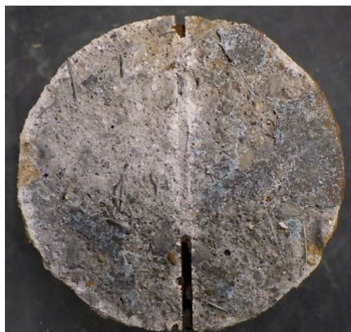
(b) ケース 2 STEP2 No. 2 (材料破壊, 界面破壊)
