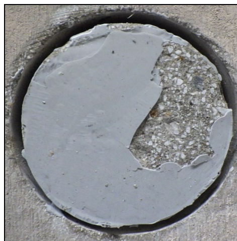
(b) No. 2 (φ100) (左側：コア, 右側：鋼床版) 治具用接着剤での破壊
