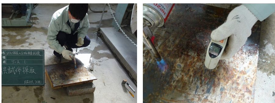
写真-2.4.3 トーチバーナによる加熱と温度測定
