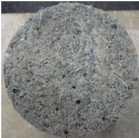
(b) ケース 1 STEP2 No. 2 (材料破壊)
