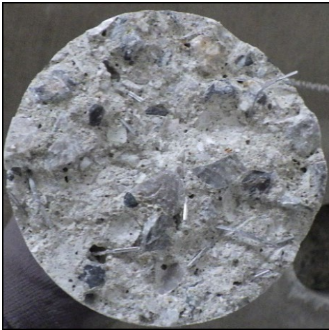
(f) No. 6 (φ80) (左側：コア, 右側：鋼床版) SFRC 舗装材料破壊
