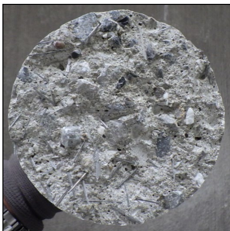
(a) No. 1 (φ100) (左側：コア, 右側：鋼床版) SFRC 舗装材料破壊
