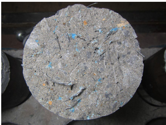
(c) No. 6 (左側：コア, 右側：鋼板) (材料破壊および凝集破壊)
