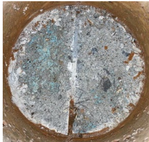
(a) ケース 3 STEP1 No. 1 (材料破壊)
