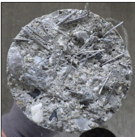
(h) No. 8 (φ80) (左側：コア, 右側：鋼床版) SFRC 舗装材料破壊
