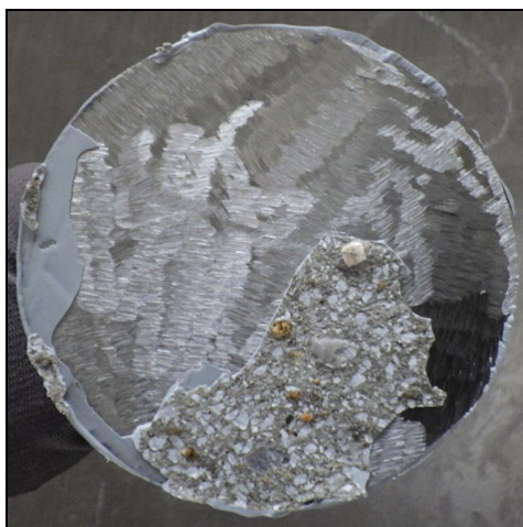
(b) No. 2 (φ100) (左側：コア, 右側：鋼床版) 治具用接着剤での破壊
