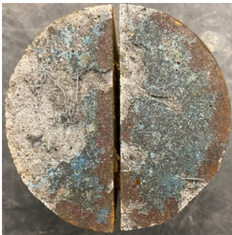
(c) ケース 2 STEP3 No. 3 (材料破壊, 界面破壊)
