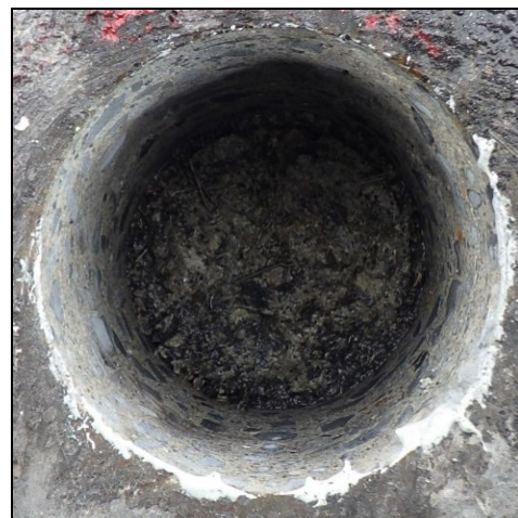
(e) No. 15 (φ80) (左側：コア, 右側：鋼床版) SFRC 舗装材料破壊
