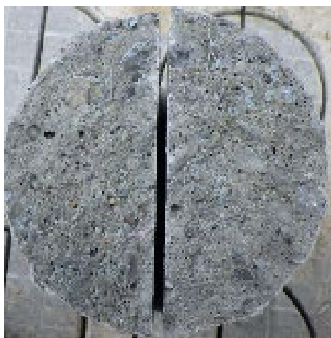
(c) ケース 2 STEP1 No. 3 (材料破壊)
