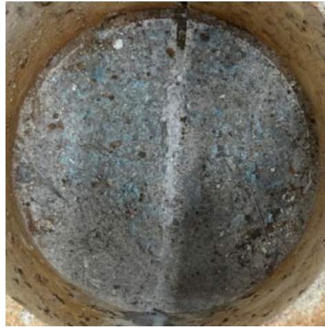
(a) ケース 3 STEP2 No. 1 (材料破壊)
