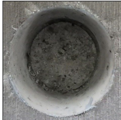
(g) No. 7 (φ80) (左側：コア, 右側：鋼床版) SFRC 舗装材料破壊
