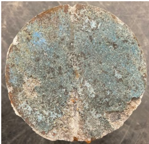
(a) ケース 2 STEP3 No. 1 (材料破壊, 界面破壊)
