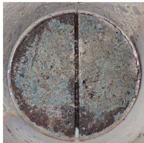
(c) ケース 3 STEP3 No. 3 (材料破壊, 界面破壊)
