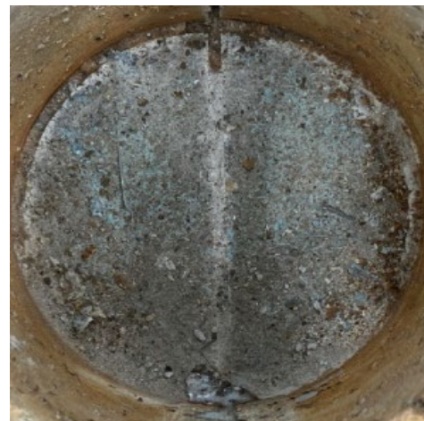
(c) ケース 3 STEP2 No. 3 (材料破壊)
