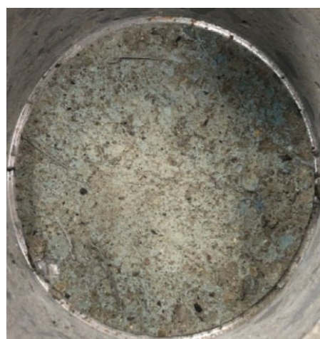
(c) ケース 1 STEP1 No. 3 (材料破壊)
