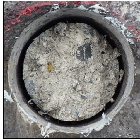
(c) No. 13 (φ80) (左側：コア, 右側：鋼床版) SFRC 舗装材料破壊
