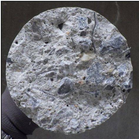
(g) No. 7 (φ80) (左側：コア, 右側：鋼床版) SFRC 舗装材料破壊
