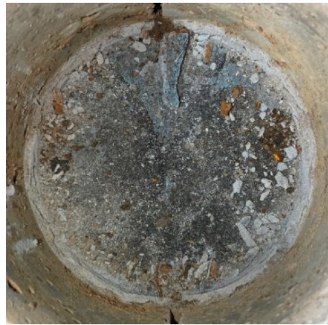
(a) ケース 2 STEP3 No. 1 (材料破壊, 界面破壊)
