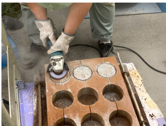
写真-2.1.19 試験体表面の研掃状況
