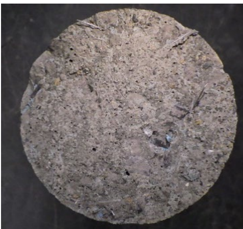
(c) ケース 1 STEP3 No. 3 (材料破壊)
