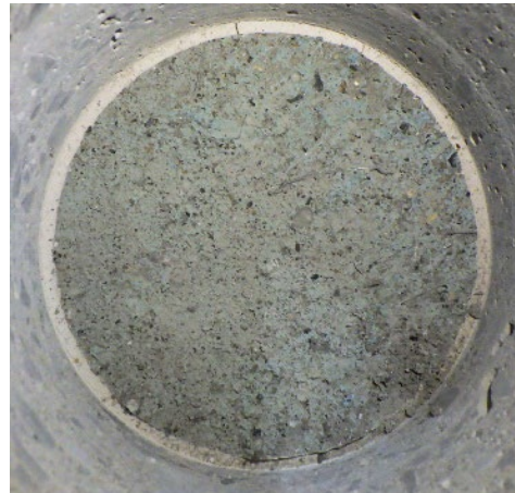
(a) ケース 1 STEP3 No. 1 (材料破壊)
