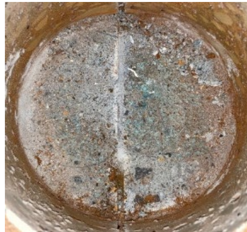
(b) ケース 3 STEP1 No. 2 (材料破壊)
