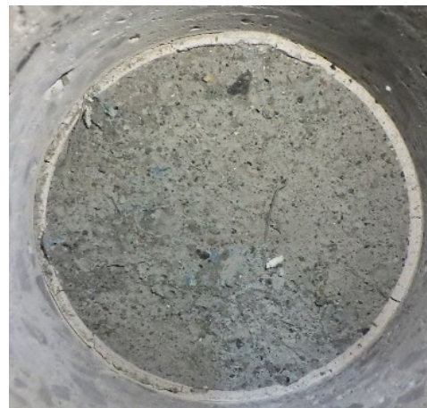
(b) ケース 1 STEP3 No. 2 (材料破壊)
