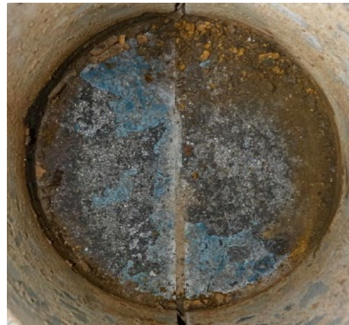
(b) ケース 2 STEP3 No. 2 (材料破壊, 界面破壊)
