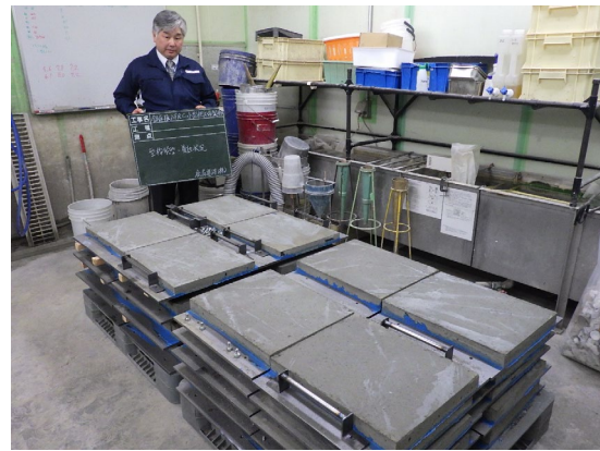
写真-2.1.10 型枠の脱型状況 (⑨)
