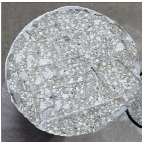
(d) No. 4 ( \phi 100 ) (左側：コア, 右側：鋼床版) 治具用接着剤での破壊
