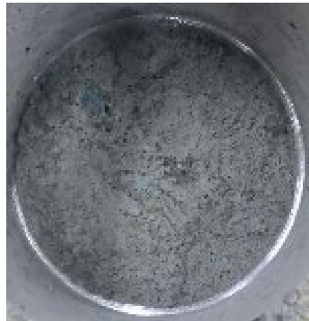
(b) ケース 1 STEP2 No. 2 (材料破壊)
