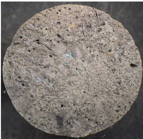
(b) ケース 1 STEP3 No. 2 (材料破壊)
