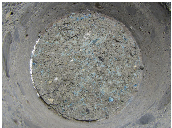
(b) No. 2 (左側：コア，右側：鋼板) (材料破壊および凝集破壊)
