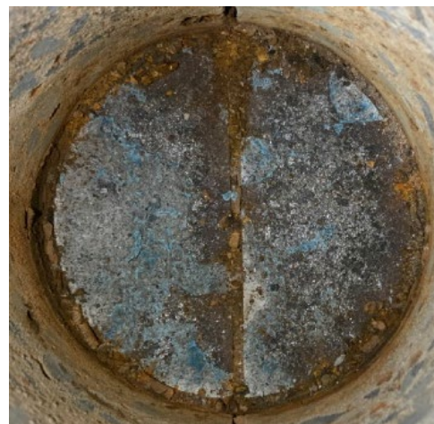
(c) ケース 2 STEP3 No. 3 (材料破壊, 界面破壊)
