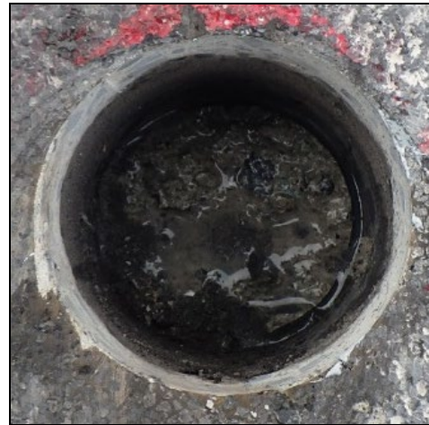
(d) No. 14 (φ80) (左側：コア, 右側：鋼床版) SFRC 舗装材料破壊
