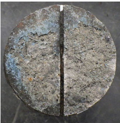
(c) ケース 3 STEP3 No. 3 (材料破壊, 界面破壊)
