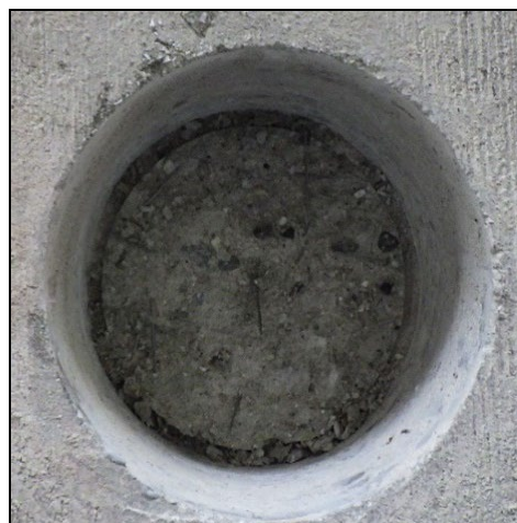
(a) No. 1 (φ100) (左側：コア, 右側：鋼床版) SFRC 舗装材料破壊
