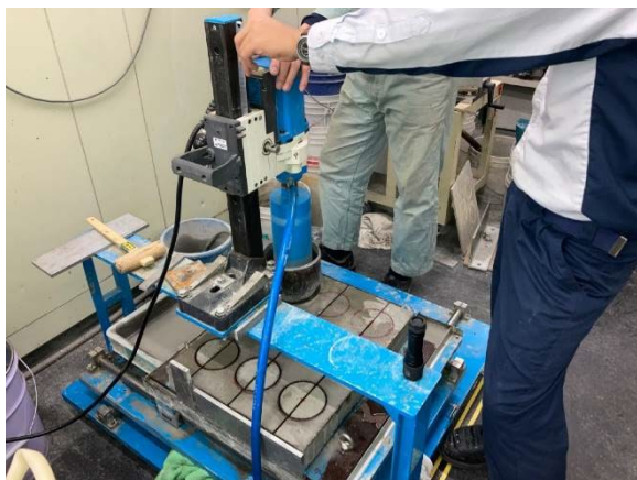
写真-2.1.14 コア切削状況
