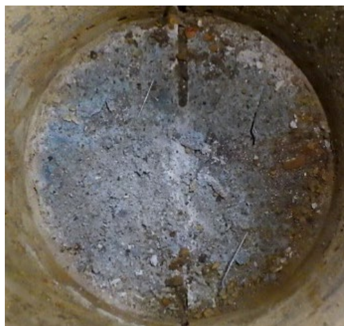
(b) ケース 2 STEP2 No. 2 (材料破壊, 界面破壊)
