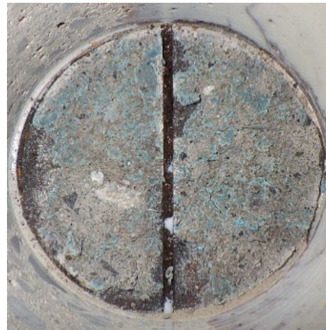
(b) ケース 3 STEP3 No. 2 (材料破壊, 界面破壊)
