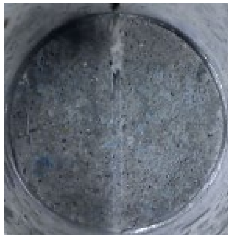
(a) ケース 2 STEP1 No. 1 (材料破壊)
