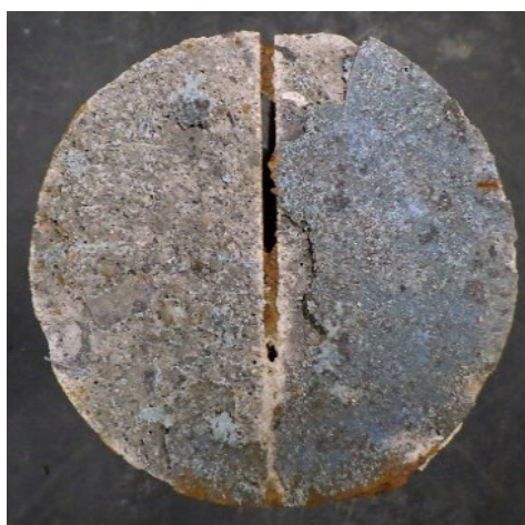
(c) ケース 2 STEP2 No. 3 (材料破壊, 界面破壊)
