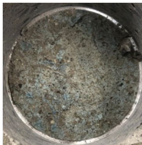
(b) ケース 1 STEP1 No. 2 (材料破壊)
