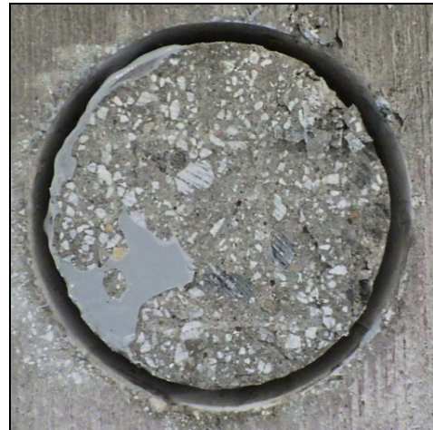
(j) No. 10 (φ80) (左側：コア, 右側：鋼床版) 治具用接着剤での破壊
