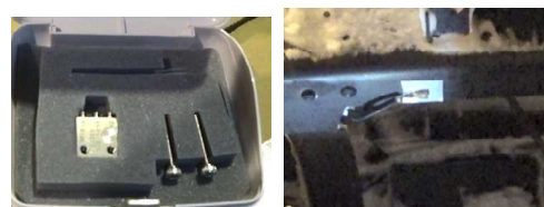
図-73 加速度ピックと設置状況
