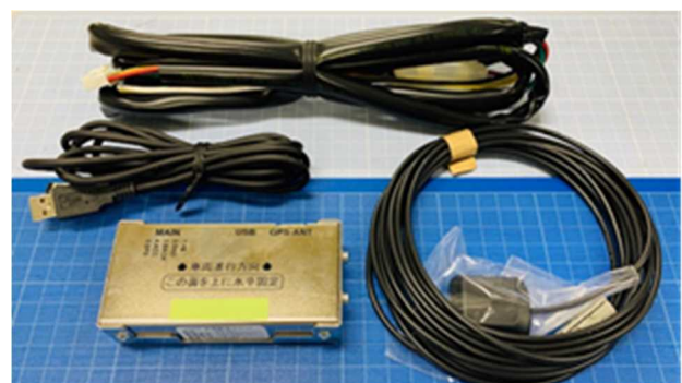
写真-10 採用したGNSSモジュール一式
