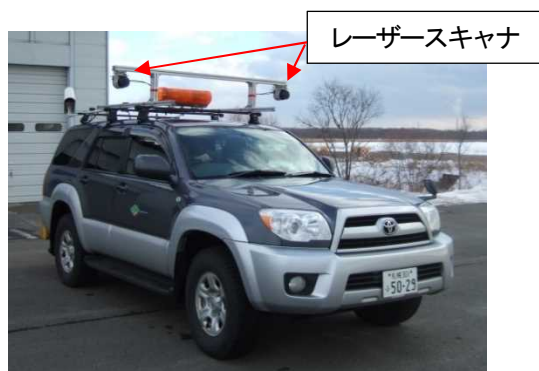
図-8 道路有効幅員計測装置の取り付け状況
