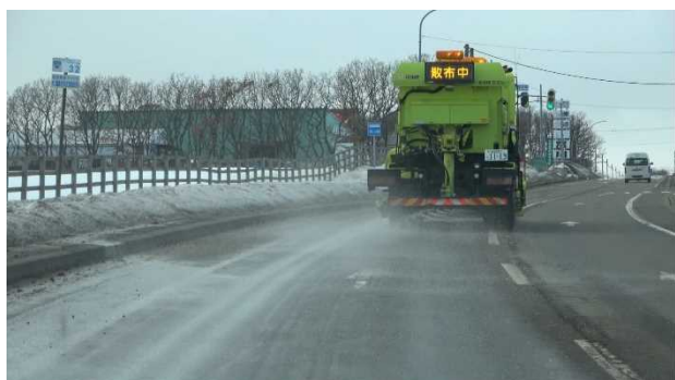
写真-20 凍結防止剤自動散布システムを搭載した除雪トラック（散布装置付き）
