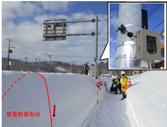
図-41 定点カメラ設置状況
