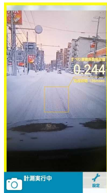
図-6 路面すべり摩擦係数推定システムの実行例
