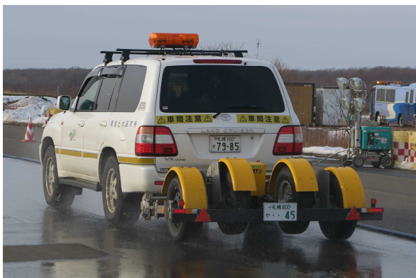
図-3 路面雪氷状態計測車両
