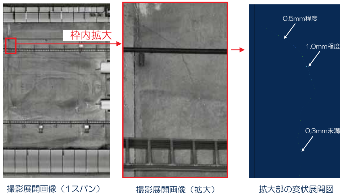
図 3-7 トンネル画像撮影・変状展開図作成例
