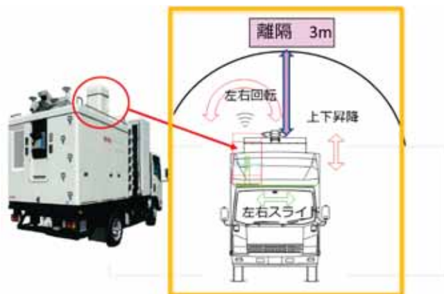
巻厚・空洞探査レーダ (既存レーダ移設:開発済み) 【 1GHz 】
