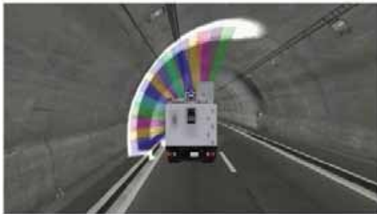
走行型計測車両MIMM-Rの走行イメージ（画像計測状況）
