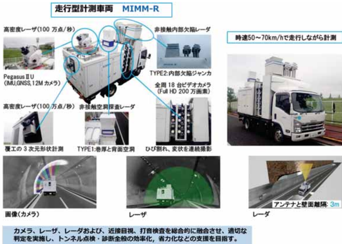
図 3-4 走行型計測システム (MIMM-R)
