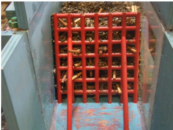
図-16 実験終了後の透過部の閉塞状況（ケース 8）
