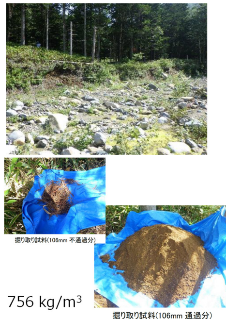
図-37 線格子法と容積法による河床堆積地と河岸段丘の調査状況
