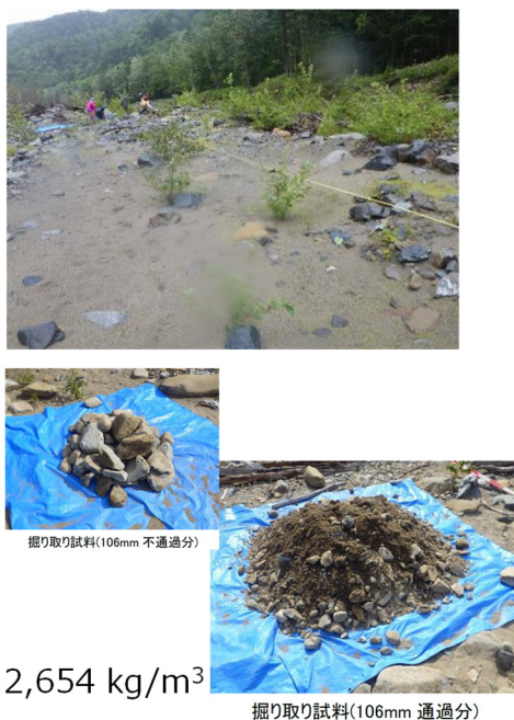
図-37 線格子法と容積法による河床堆積地と河岸段丘の調査状況
