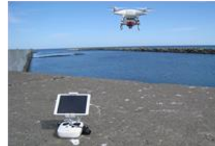
写真-1 空撮に使用したマルチコプター
